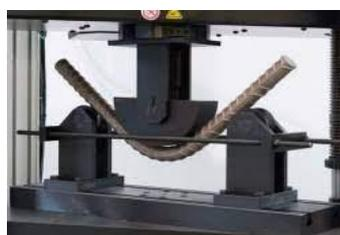
Gambar 2.5 Alat Pengujian *Bending* Plat Baja
