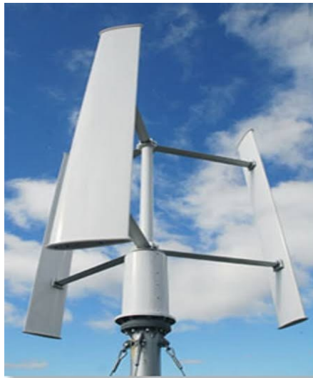
Gambar 2. 3Turbin Darreus Sumber: (Fadila, A.2020)
