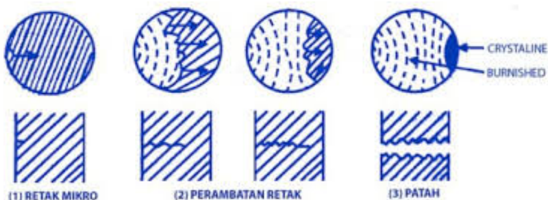
Gambar 15. Kelelahan Material (Fatigue), (PT Tensor Karya Nusantara, 2021)
