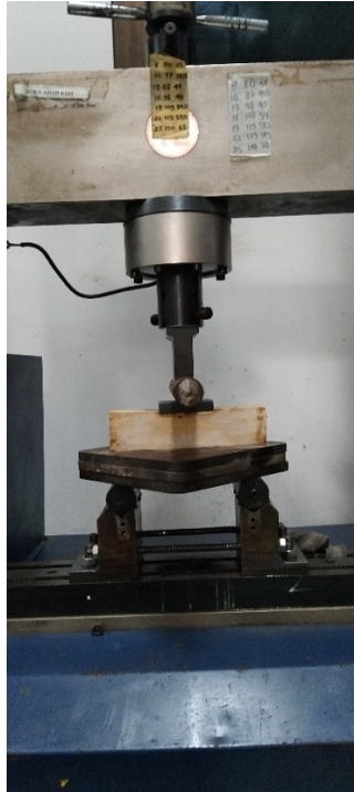
Gambar 18. Set up benda uji kuat Lentur (Data Primer, 2024)
