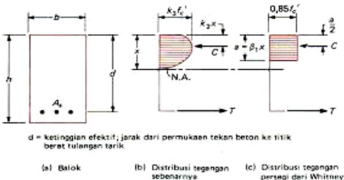
Gambar 2. Distribusi tegangan regangan balok beton bertulang
