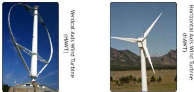
Gambar 2. 2 Turbin angin sumbu horizontal (Sumber: Hau, E. 2006 )
