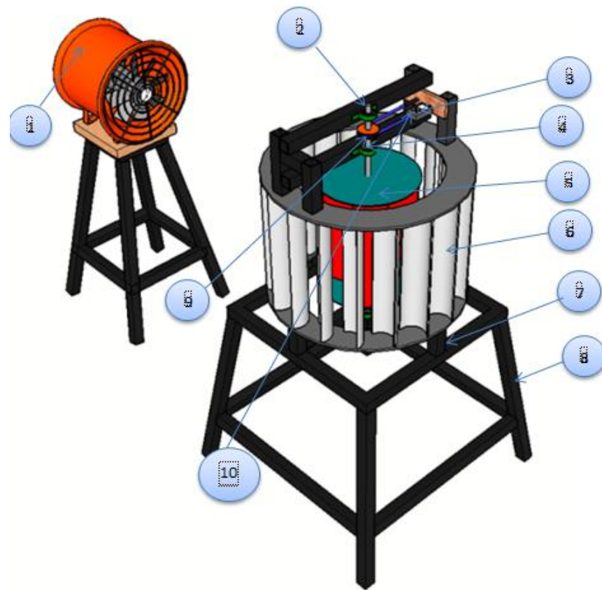
Gambar L. 1 Lay Out Turbin Angin Savonius dengan Cylindrical Guide Vane
