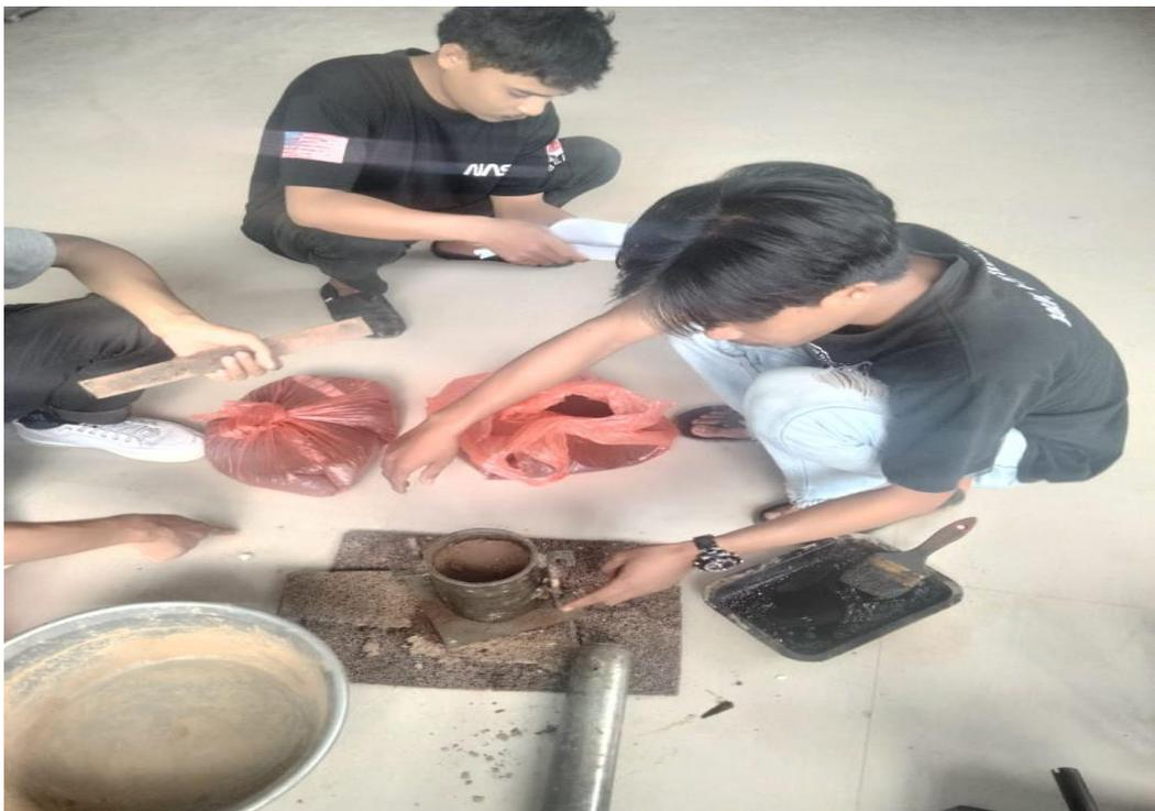
Pengujian Pemadatan Tanah (Kompaksi)
