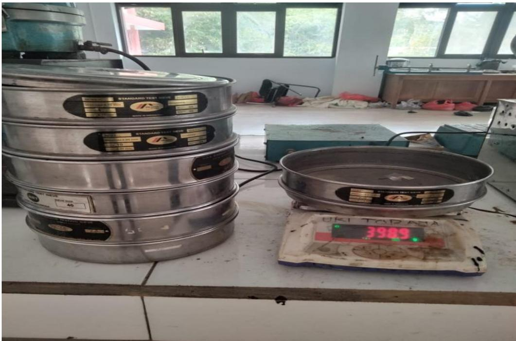
Pengujian analisa saringan tanah
