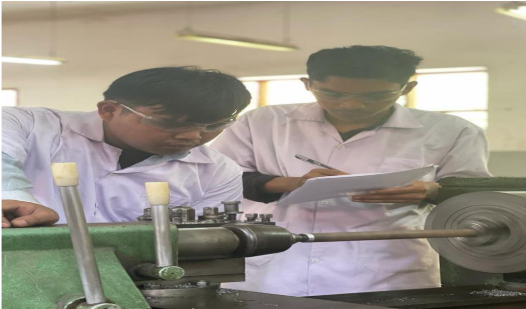
Gambar L 3: Memulai proses pembubutan benda kerja baja ST 42
