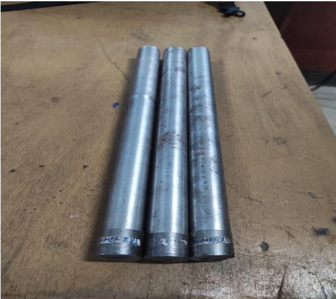
Gambar L 4: Hasil pembubutan baja ST 42
