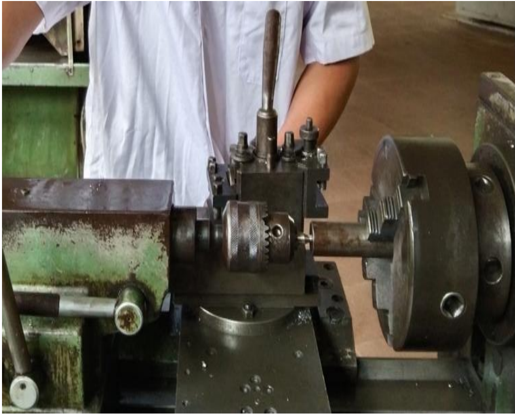
Gambar L 1: Pembuatan senter bor pada benda kerja
