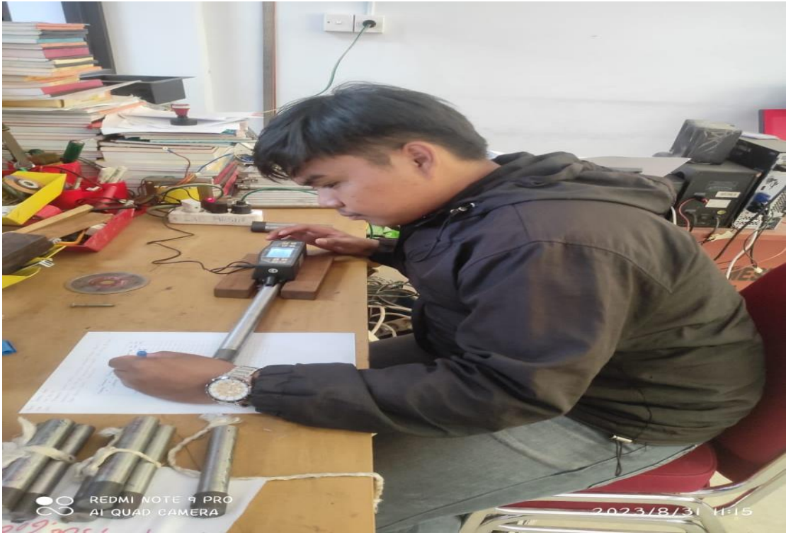
Gambar L 5: Pengukuran hasil pembubutan baja ST 42 menggunakan alat Surface roughness tester
