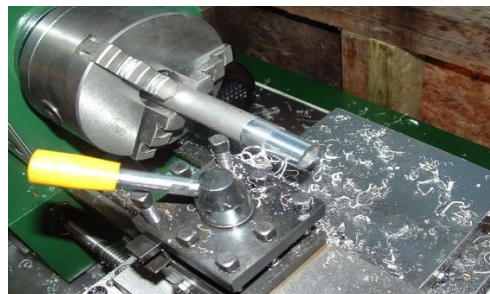
Gambar 2. 14 Proses pembubutan kering Sumber: (S Sunarto, S Mawarni ,2018)
