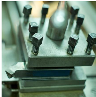
Gambar 2. 5 Toolpost / Tempat Pahat Sumber: (Muhammad Reza Furqoni)
