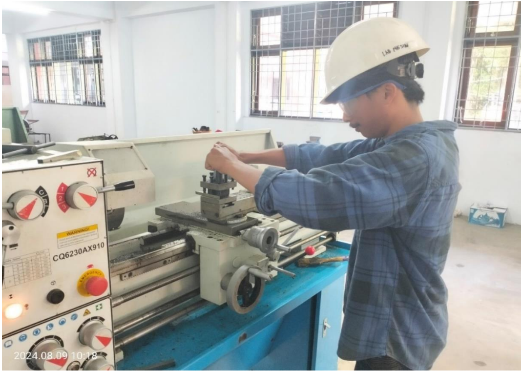
Gambar L.3 proses pemasangan pahat bubut
