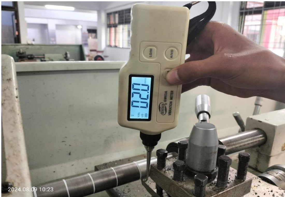
Gambar L.7 pengukuran kecepatan getaran pahat menggunakan vibration meter
