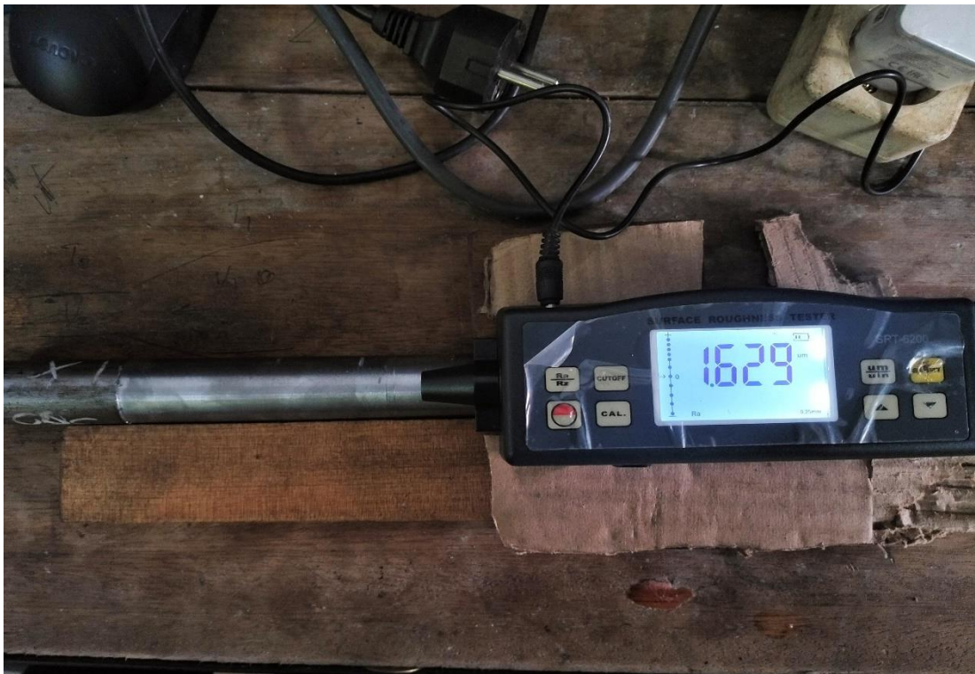
Gambar L.10 mengukur kekasaran permukaan menggunakan Surface Roughness Tester
