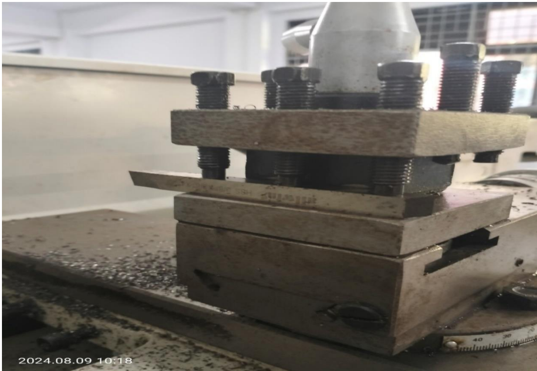
Gambar L.4 pahat setelah dipasang di eretan
