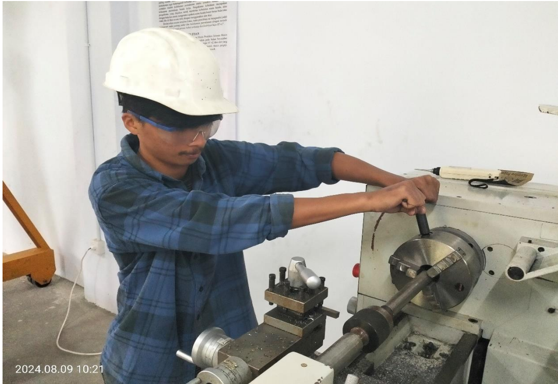
Gambar L.5 pemasangan spesimen pada cekam mesin bubut
