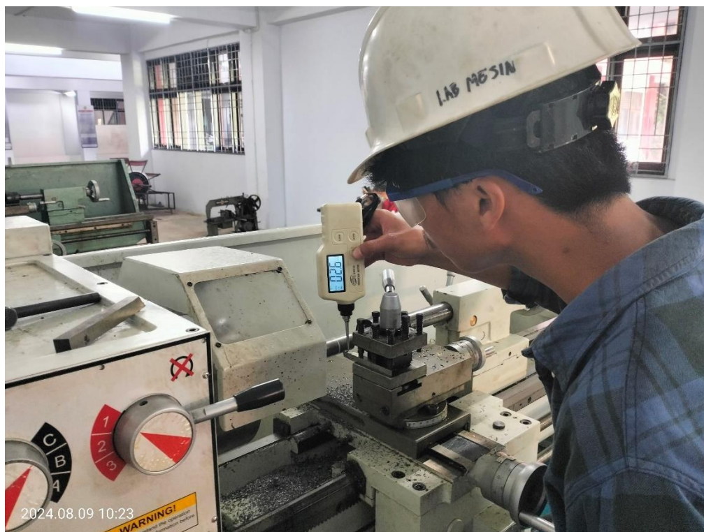
Gambar L.6 pengukuran getaran pahat
