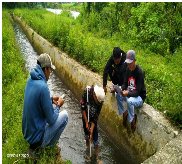
Gambar L-2.6. Pengukuran Kecepatan Aliran Air
