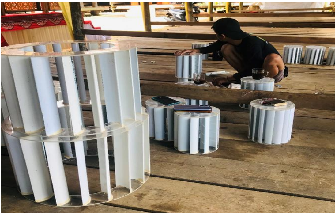
Gambar L. 19 Rotor dan Cylindrical guide vane setelah pengeleman
