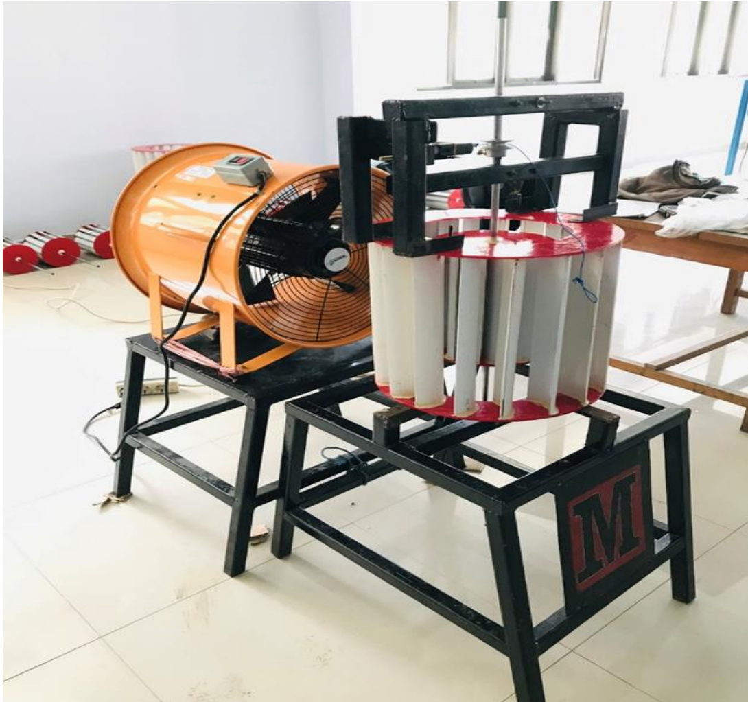
Gambar L. 24 Turbin angin crossflow 12 sudu menggunakan Cylindrical guide vane
