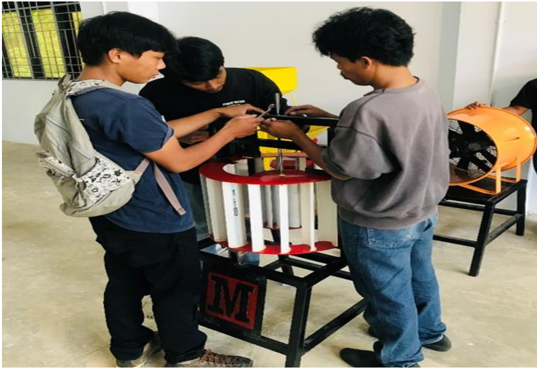
Gambar L. 22 Pemasangan rotor dan Cylindrical guide vane
