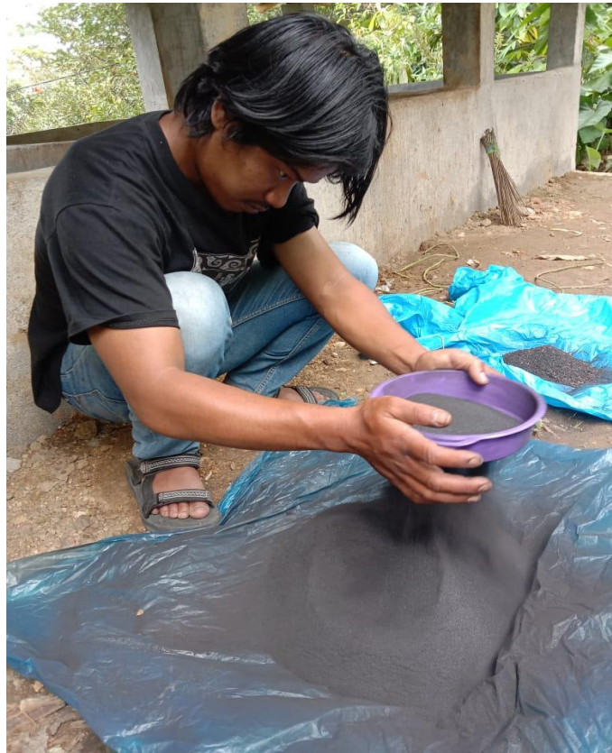
Gambar L-5 Pengayakan arang tempurung kelapa
