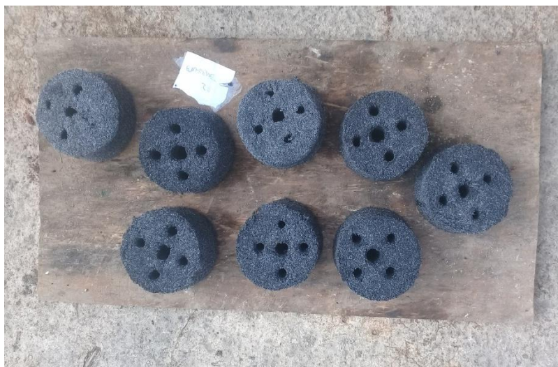
Gambar L-8 Proses pengeringan briket
