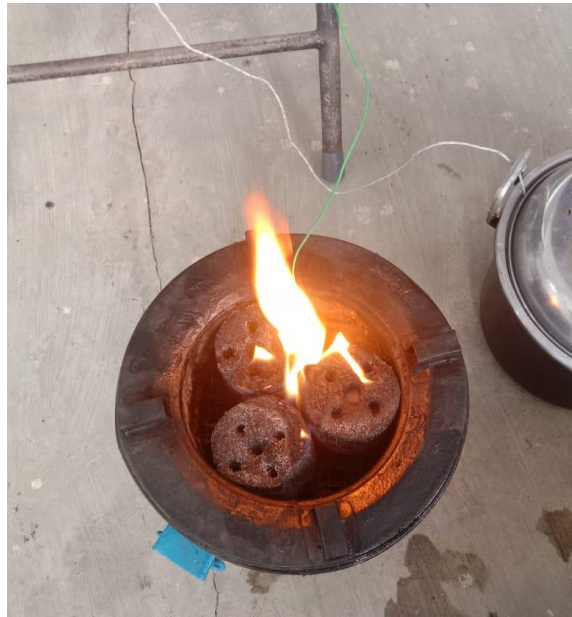
Gambar L-9 Proses pembakaran briket
