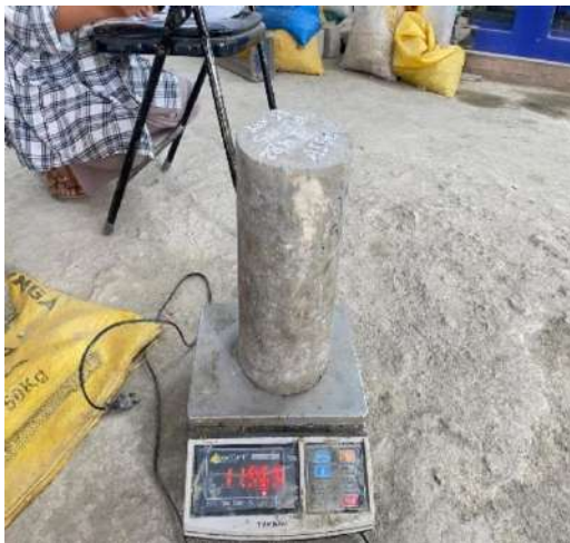
Beton Variasi Akk 5% + Sp 1,5% I
