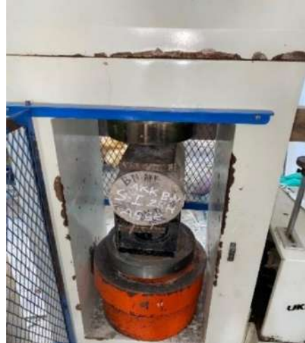
Beton Kontrol Sampel I
