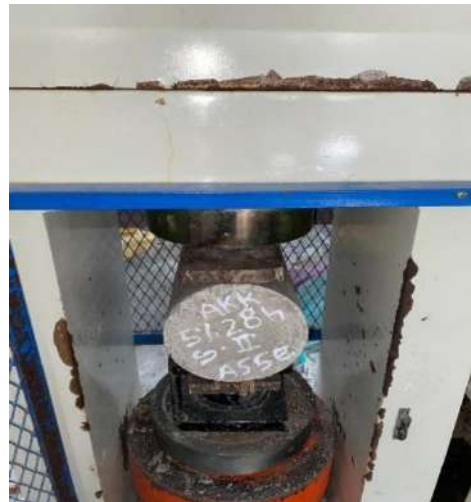
Beton Variasi Akk 5% + Sp 1,5% I
