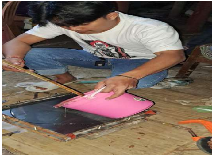
LP 7. Penuangan resin ke cetakan
