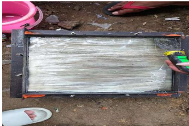
LP 8. Penyusunan serat ke cetakan
