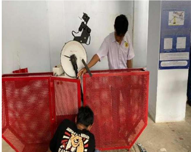
LP 13. Proses pengujian impak
