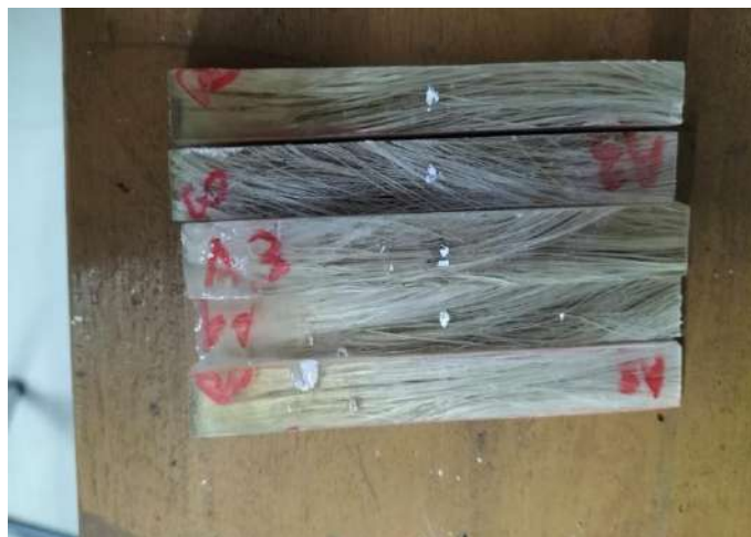
LP 11. Hasil pembuatan spesimen impak
