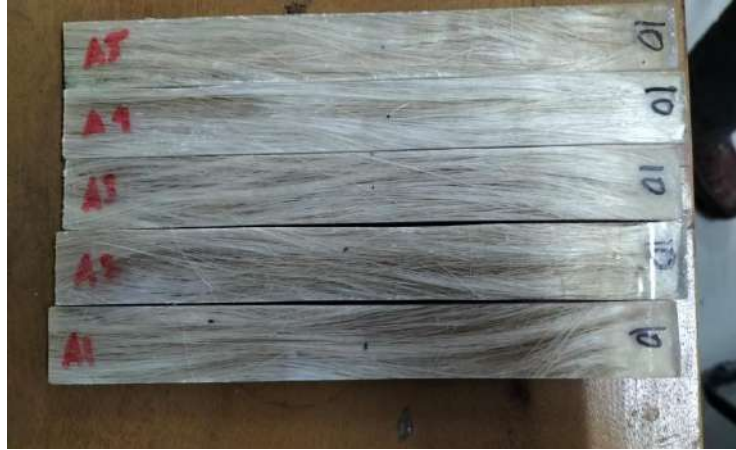
LP 10. Hasil pembuatan spesimen bending
