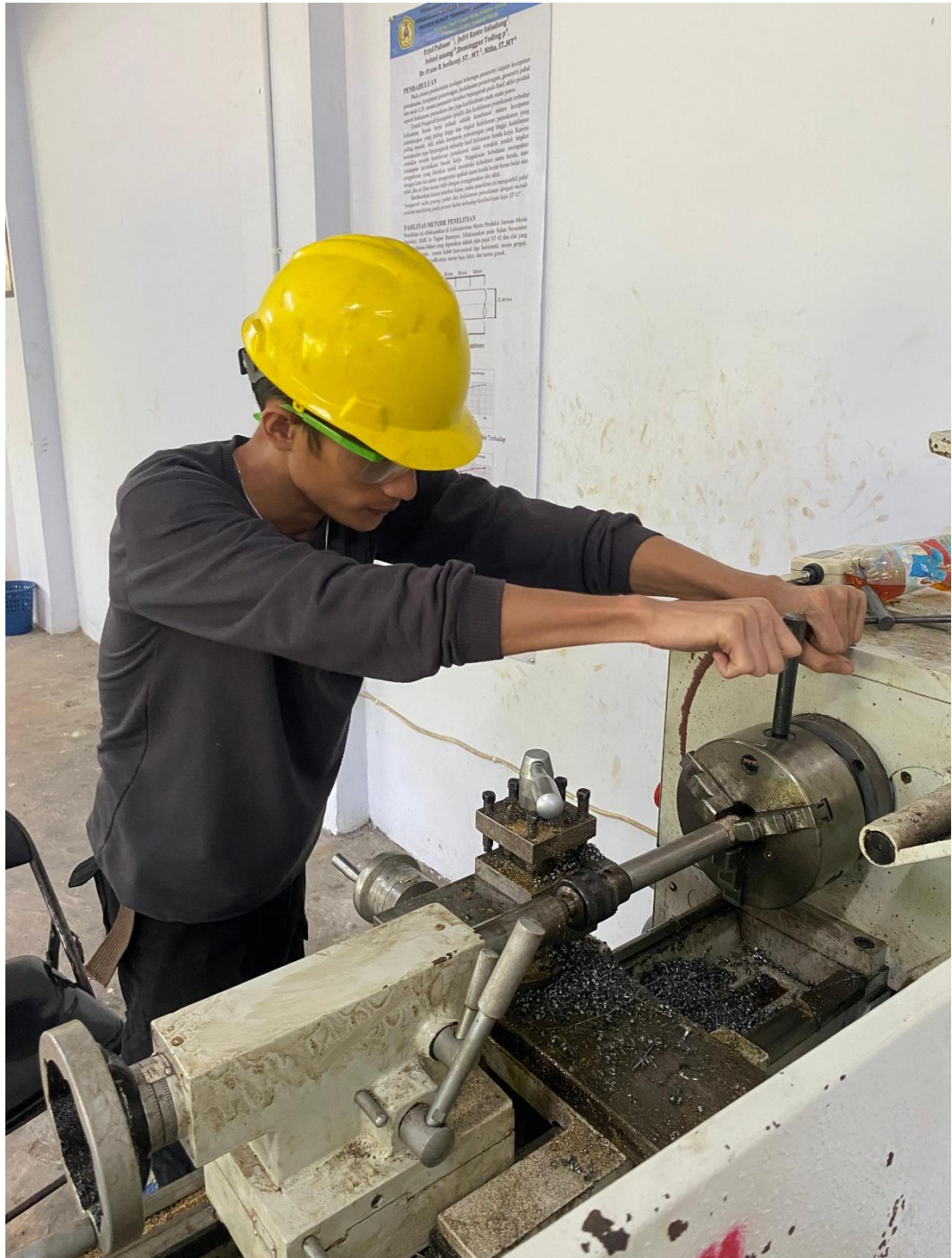
L1. Pemasangan spesimen baja ST37
