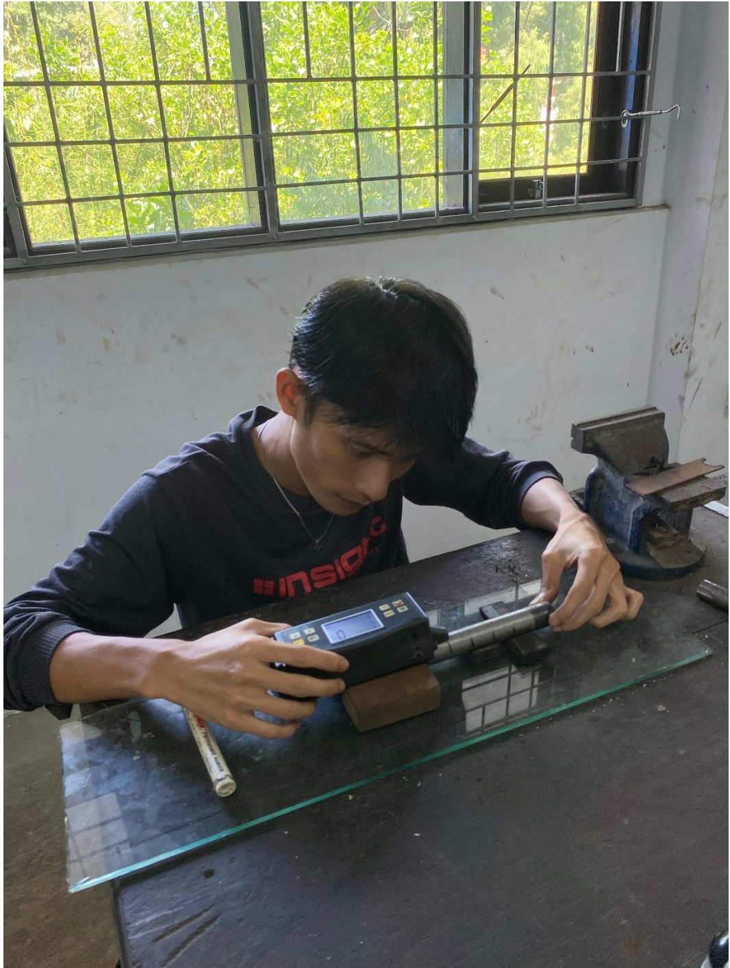
L5. Proses Pengukuran Kekasaran Permukaan baja ST37
