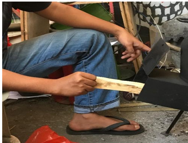
L.20 Proses memasukan kayu bahan bakar dalam tungku
