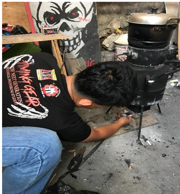
L.26 Mengambil data kecepatan udara menggunakan anemometer
