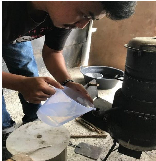
L.18 Proses memasukkan air injeksi ke dalam ruang injektor
