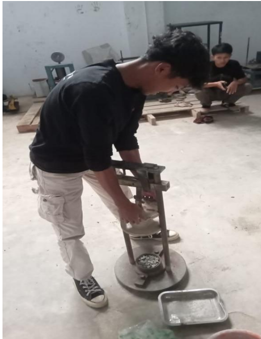
Pengujian kekuatan agregat terhadap tumbukan
