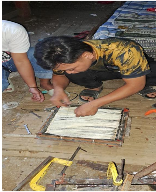
L6 Proses Peletakan Serat Kedalam Cetakan
