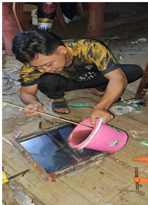
L5. Proses Penuangan Resin Kedalam Cekatakan
