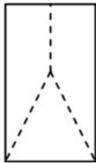
Gambar 2.2 Bentuk kehancuran kerucut dan belah
