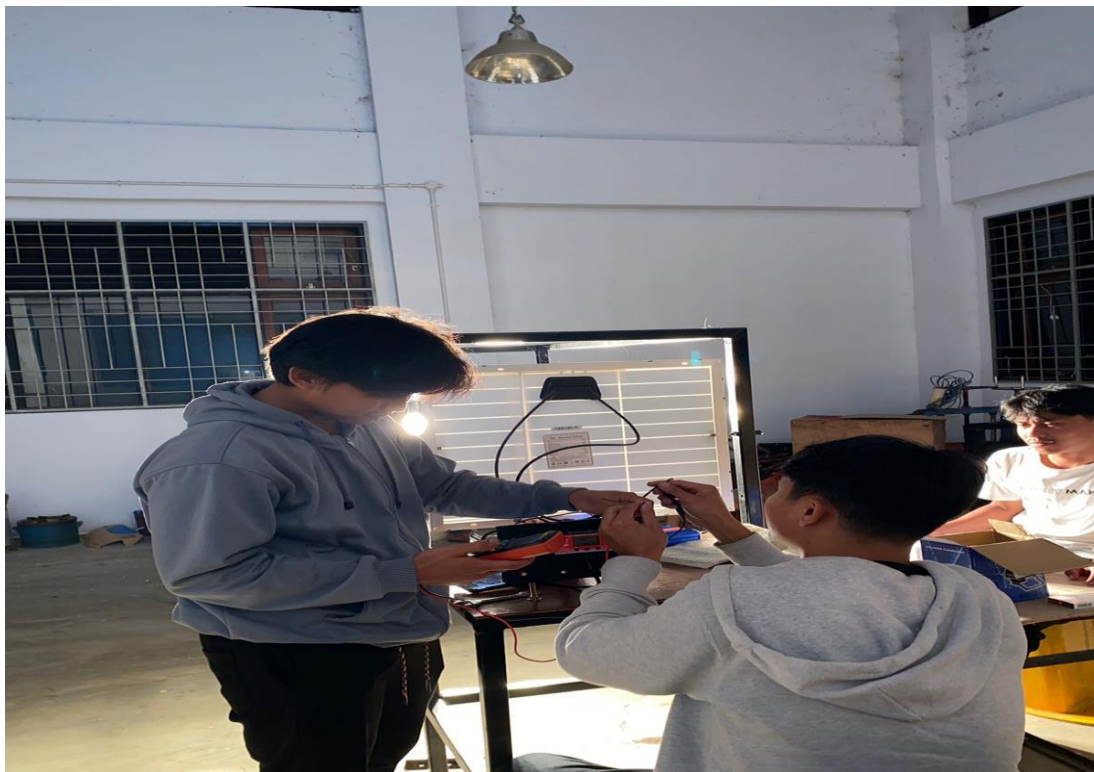
Gambar L-. 5 Pengambilan data Voc dan Isc
