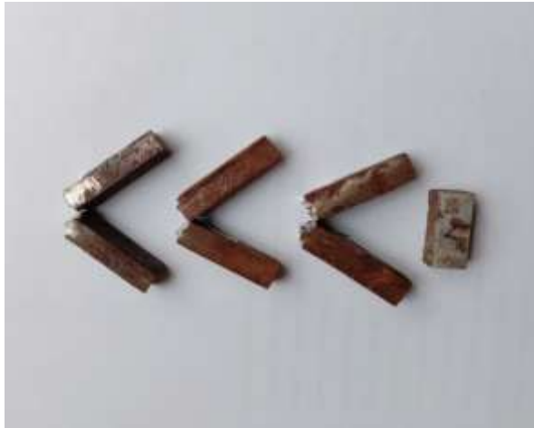
Gambar L 14. Hasil pengujian 15 Psi ketangguhan dan struktur mikro
