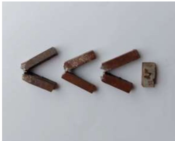
Gambar L 15. Hasil pengujian 10 Psi ketangguhan dan struktur mikro
