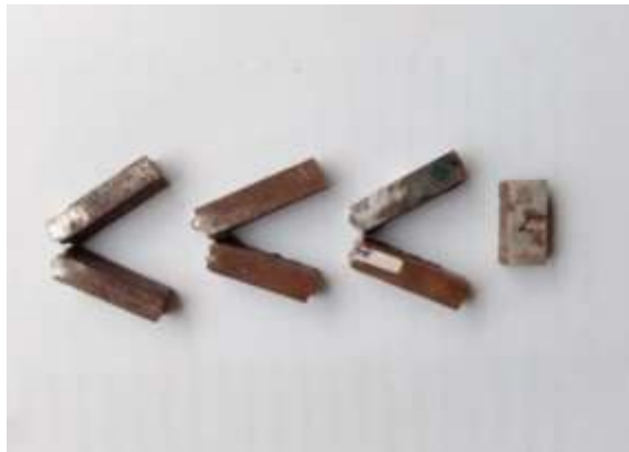
Gambar L 12. Hasil pengujian normal ketangguhan dan struktur mikro
