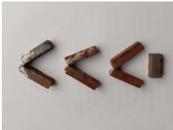
Gambar L 13. Hasil pengujian 20 Psi ketangguhan dan struktur mikro
