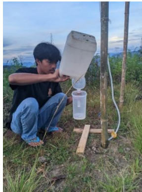
Pengukuran dan pencatatan volume air pada wadah penampung SFC
