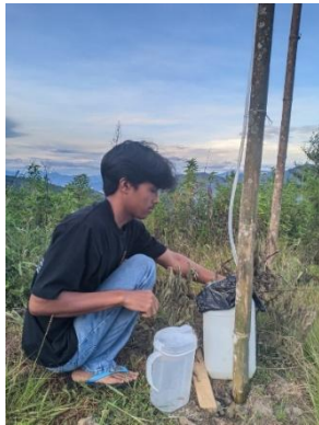
Pengukuran dan pencatatan volume air pada wadah penampung SFC
