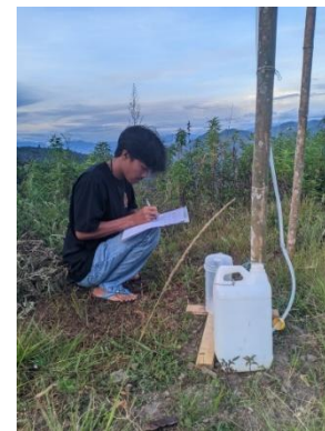
Pengukuran dan pencatatan volume air pada wadah penampung SFC
