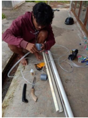
Perakitan komponen Standard Fog Collector
