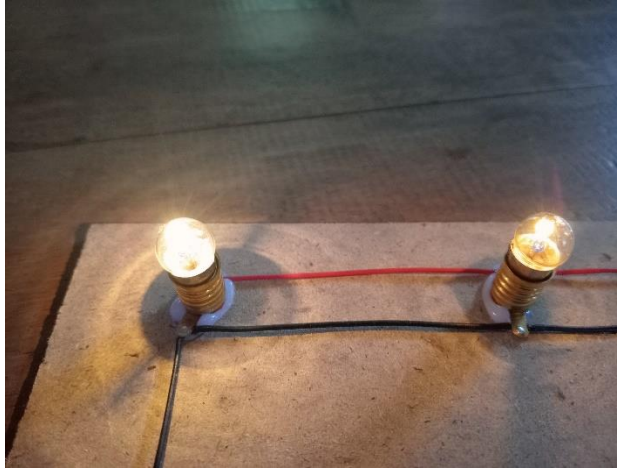
Cahaya lampu yang dihasilkan bio-baterai kulit pisang+larutan garam
