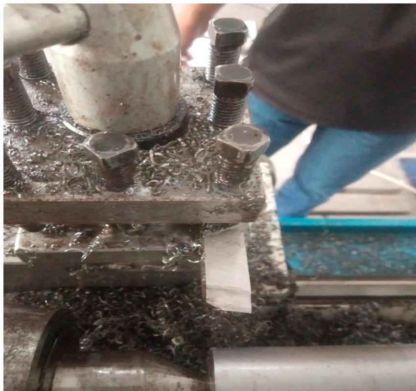
L12 Pemasangan pahat
