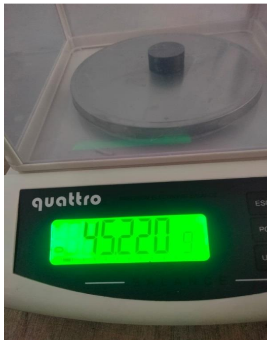
Gambar L. 14. Penimbangan berat awal specimen sebelum uji keausan
