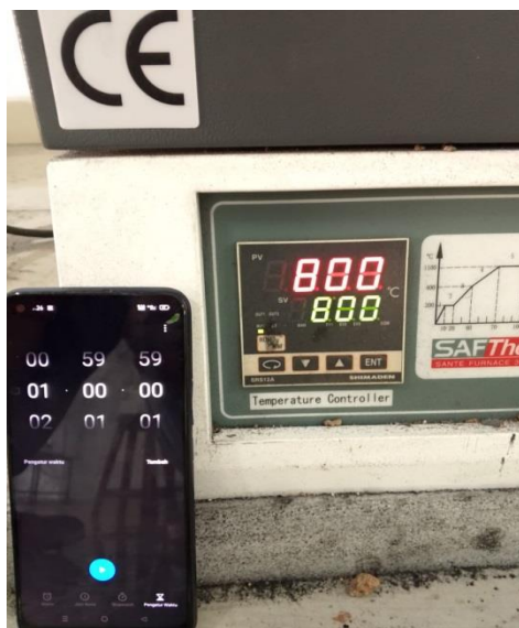
Gambar L. 10. proses pack carburizing dengan temperatur 800^{\circ} selama 1 jam
