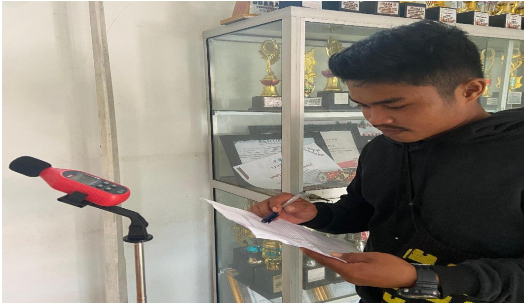
Pengambilan data kebisingan lalu lintas dengan alat sound level meter
