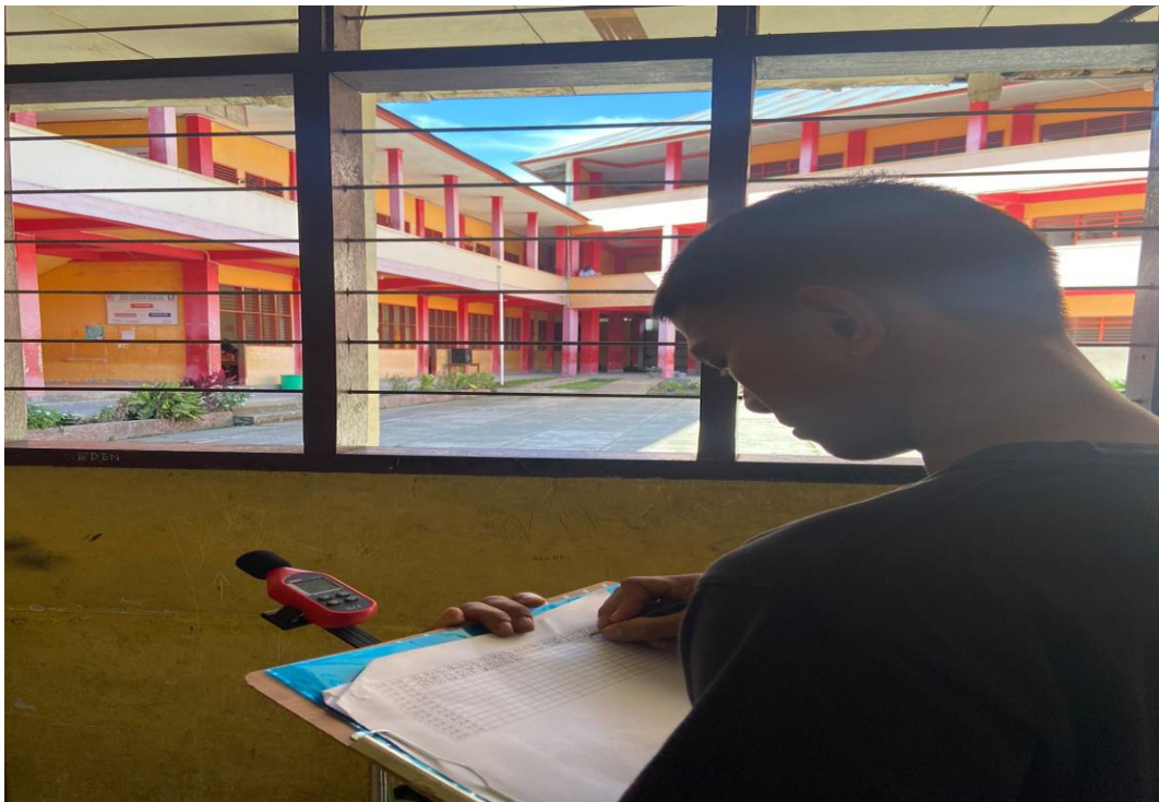
Pengambilan data kebisingan lalu lintas dengan alat sound level meter
