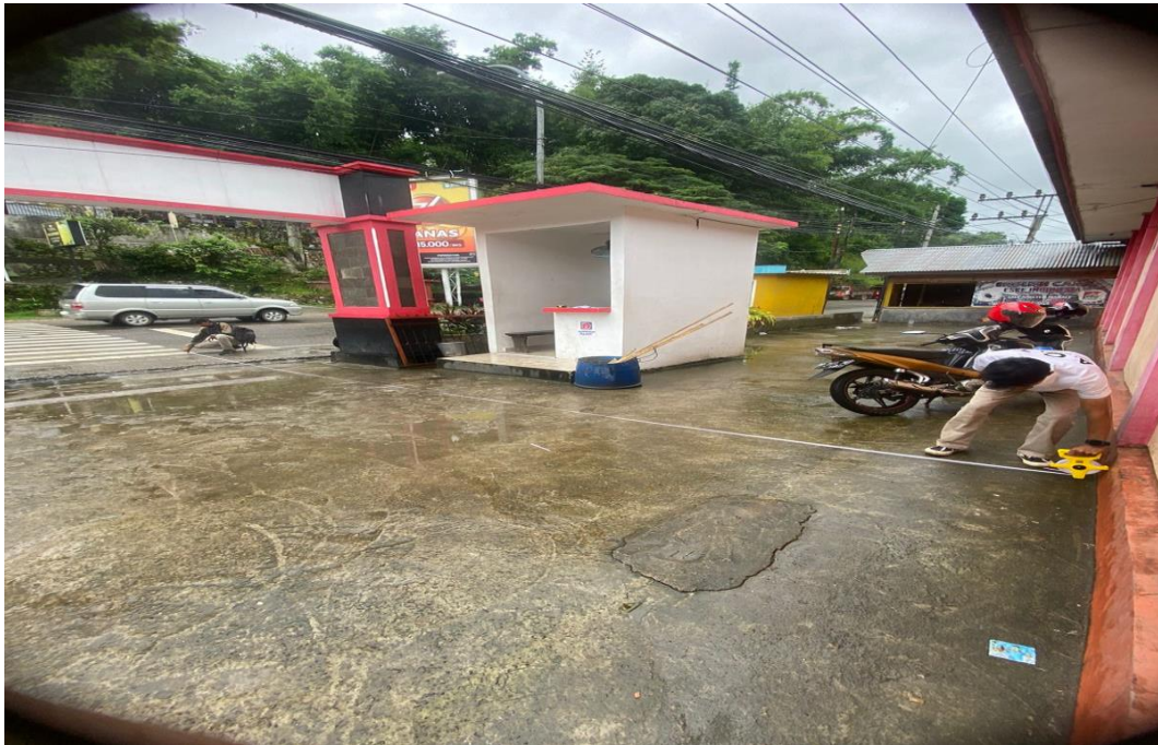
Pengukuran jarak perhitungan kecepatan kendaraan dan jarak titik penempatan alat sound level meter dari as jalan
