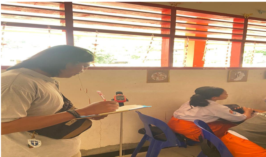
Pengambilan data kebisingan lalu lintas dengan alat sound level meter
