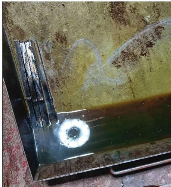
Process pencelupan baja A36 pada media pendinginan oli SAE 40 ( Quenching process with SAE oil 40 ).
