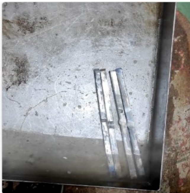
Process pencelupan baja A36 pada media pendinginan air garam ( Quenching process with brine ). (Dokumentasi, 2025)
