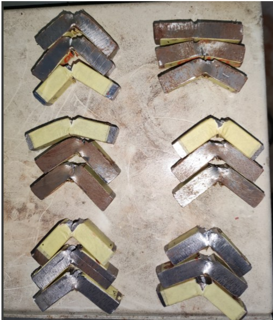
Spesiment hasil uji impact /ketangguhan dengan mesin Charpy.
