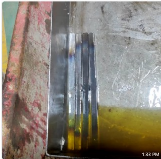
Process pencelupan baja A36 pada media pendinginan oli SAE 30 ( Quenching process with SAE oil 30 ). ( Dokumentasi, 2025 )
