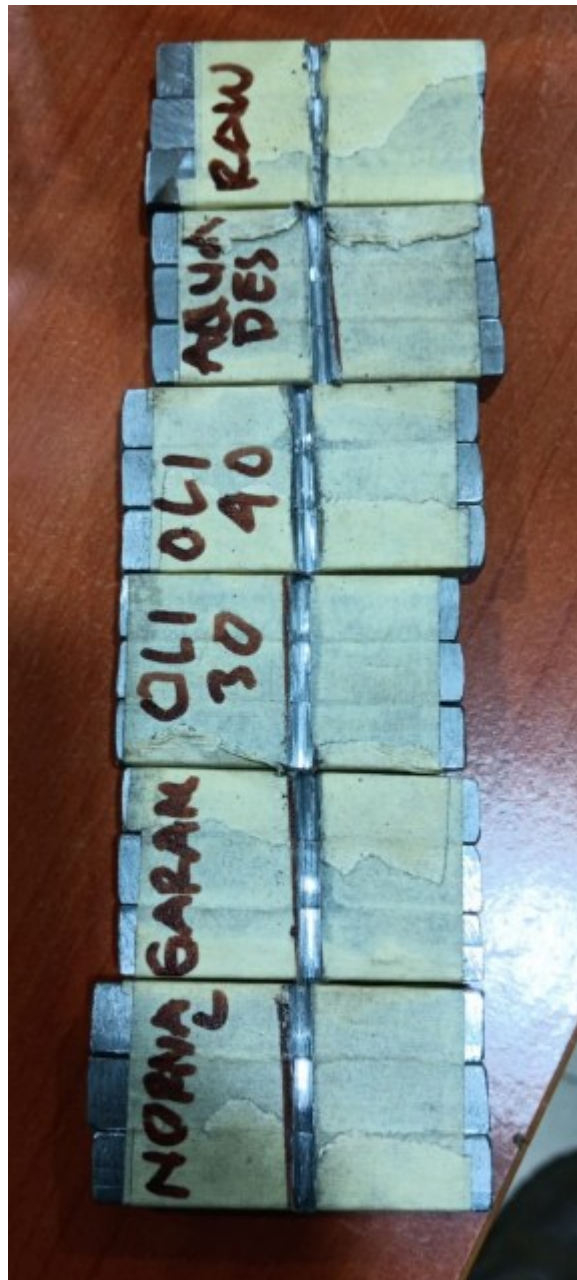
Spesimen penelitian pengelasan baja A36 dengan variasi media pendingin yang telah di takik untuk pengujian pada mesin Charpy dengan standard ASTM E23 ( V-north Charpy ). ( Dokumentasi, 2025 )
