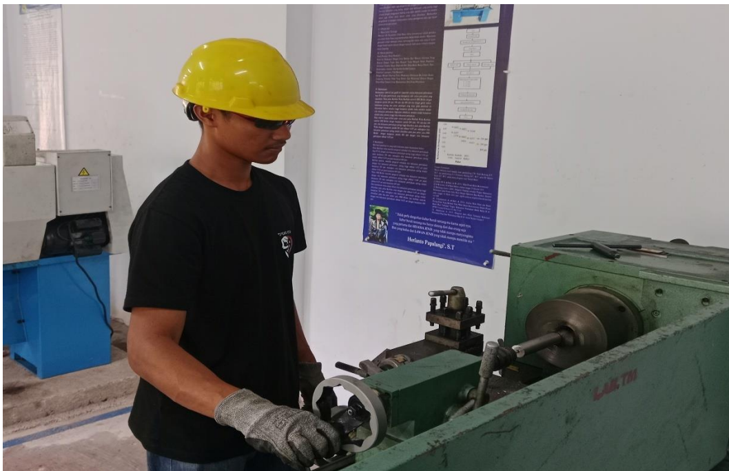
Gambar 2. Proses pembuatan center bore pada spesimen
