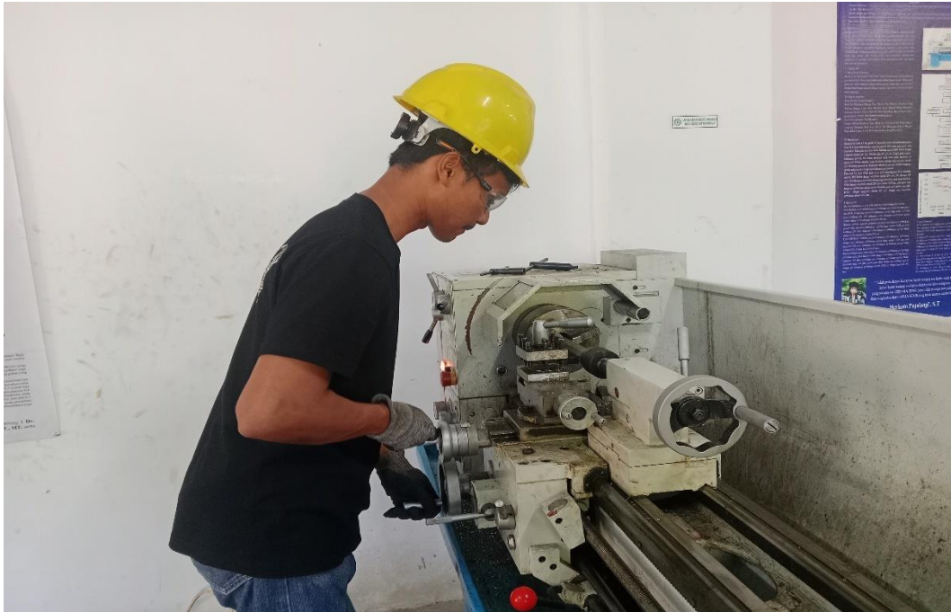
Gambar 5. Mengatur kedalaman potong pada spesimen
