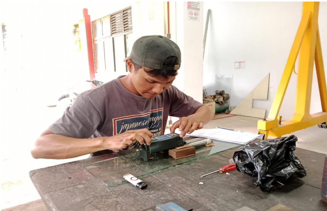
Gambar 8. Pengukuran kekasaran permukaan spesimen
