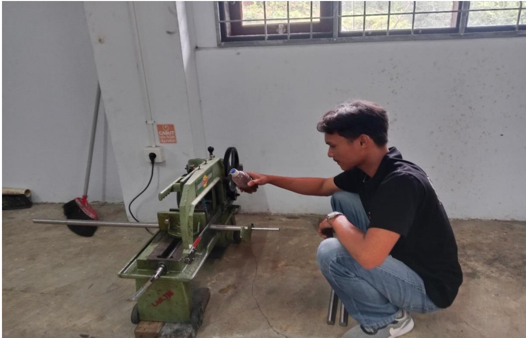
Gambar 1. Pemotongan pesimen Stainless steel 304
