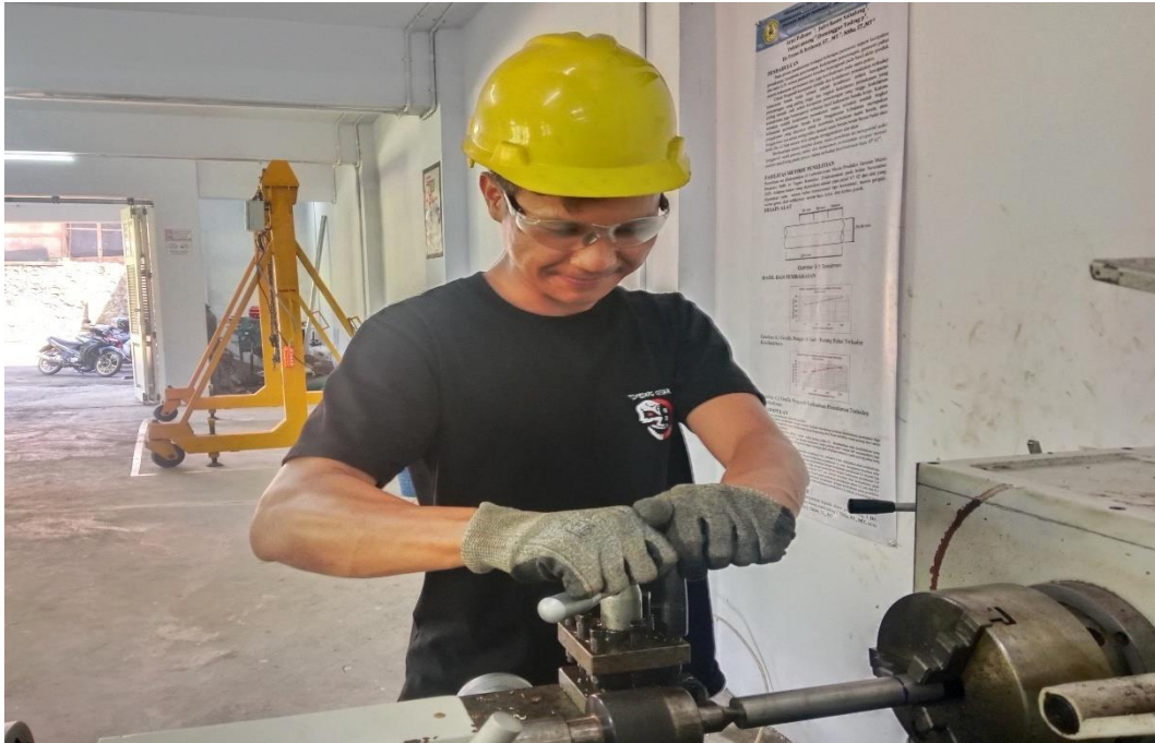
Gambar 3. Proses pemasangan pahat bubut
