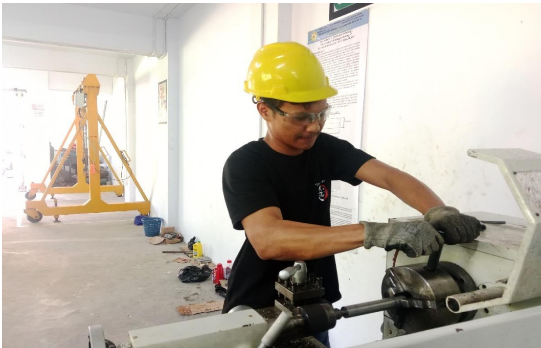
Gambar 4. Pemasangan spesimen pada cekam mesin bubut
