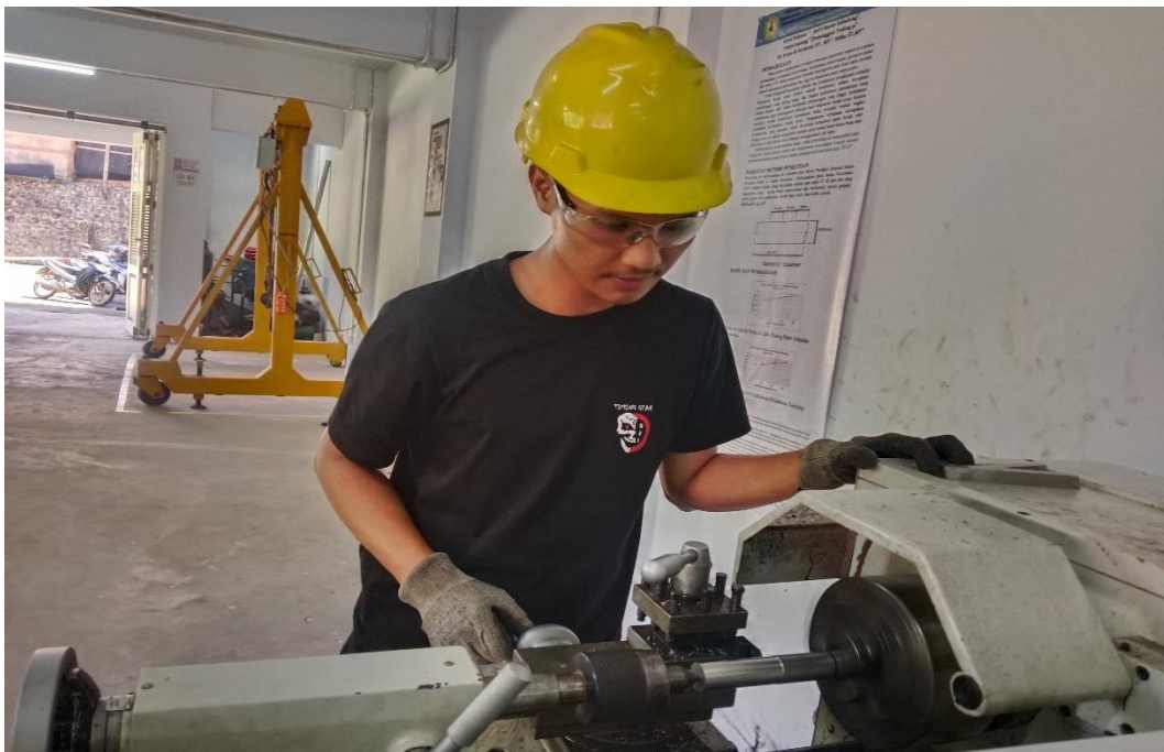
Gambar 6. Proses pembubutan spesimen
