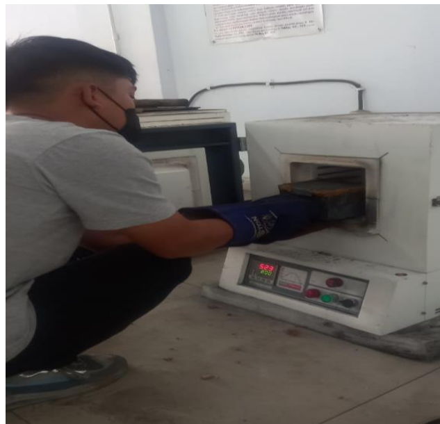
Gambar L. 10 Proses memasukkan kotak baja
