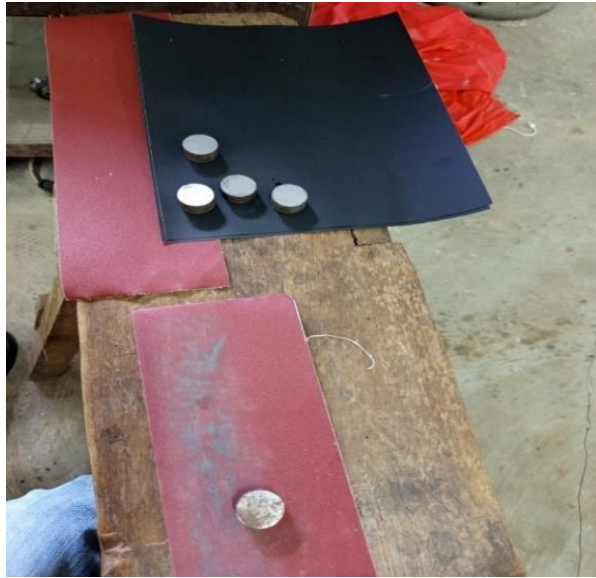
Gambar L. 5 Proses menghaluskan permukaan spesimen
