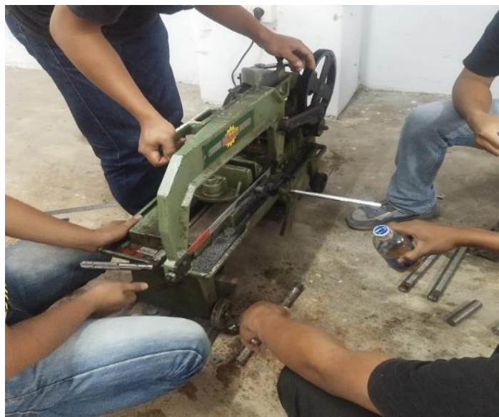
Gambar L. 4 Proses pemotongan baja ST 37
