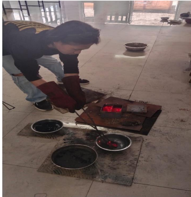
Gambar L. 13 Proses mendinginkan spesimen
