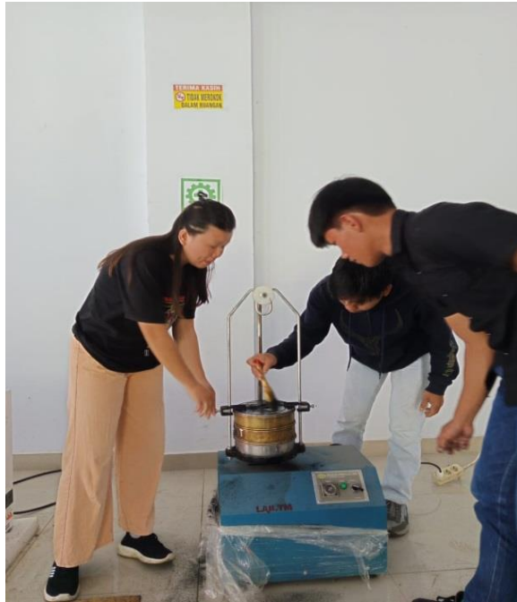
Gambar L. 3 Proses pengayakan arang cemara dengan mesh 30
