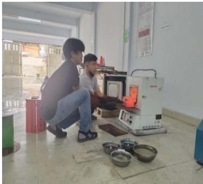
Gambar L. 12 Mengeluarkan kotak baja dari dalam tungku
