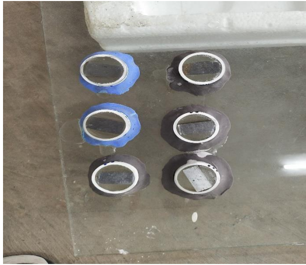
Gambar L. 15 Proses pelapisan resin terhadap spesimen
