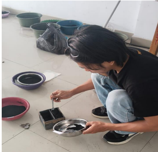
Gambar L. 9 Proses memasukkan spesimen, arang cemara dan \text{NaCO}
