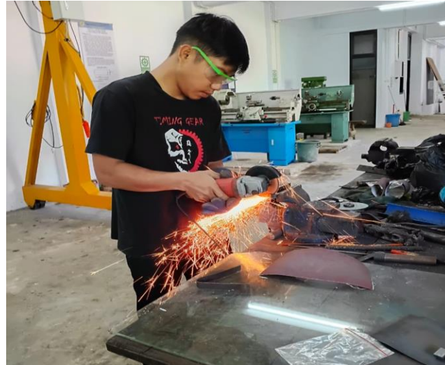
Gambar L. 14 Proses membelah dua spesimen
