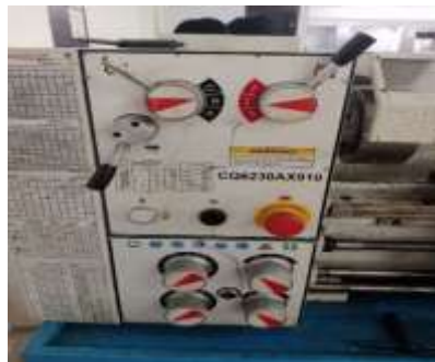
Gambar 2.8 Tuas pengatur kecepatan sumbu utama
