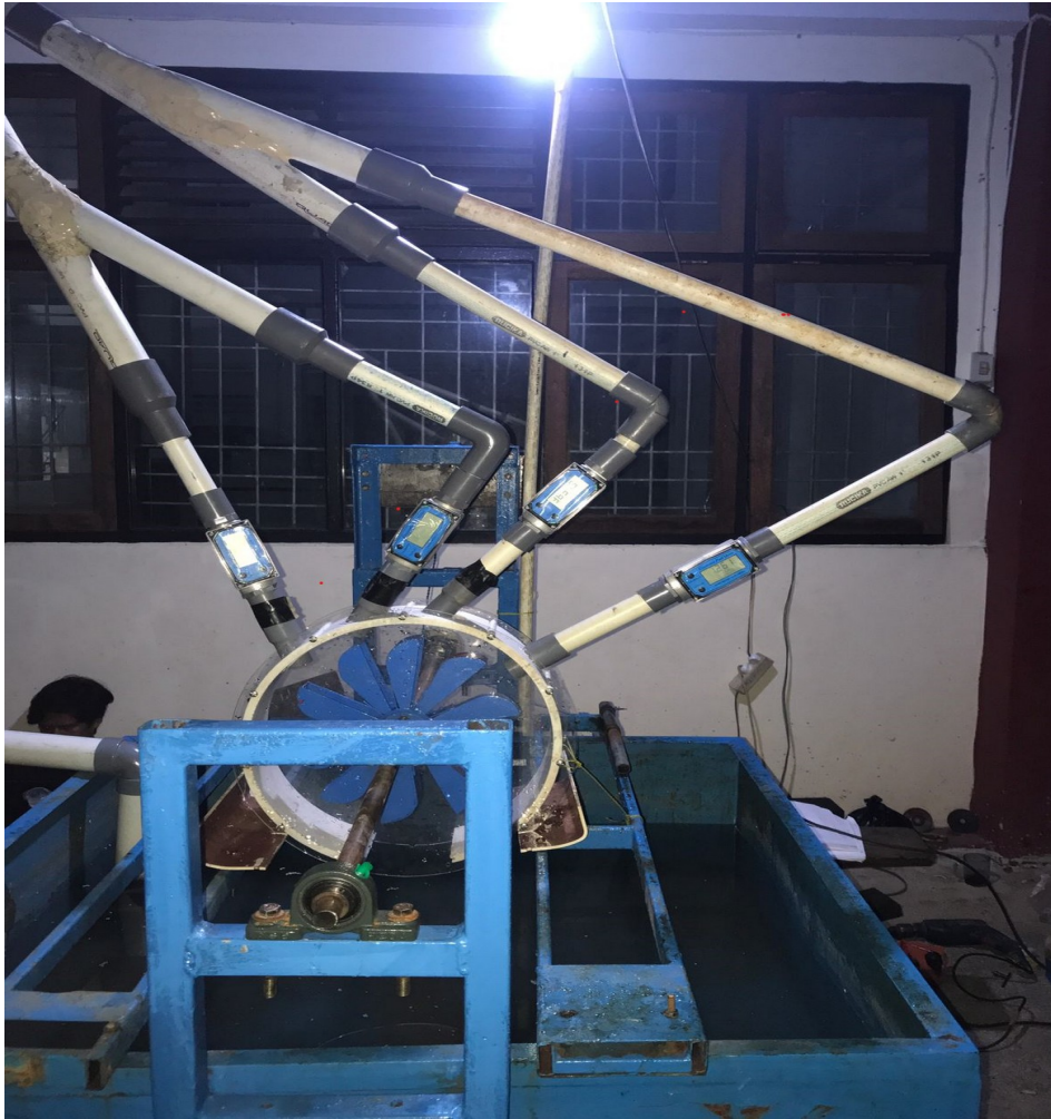
Gambar L. 12 Turbin Turgo Dengan 4 Nozzle
