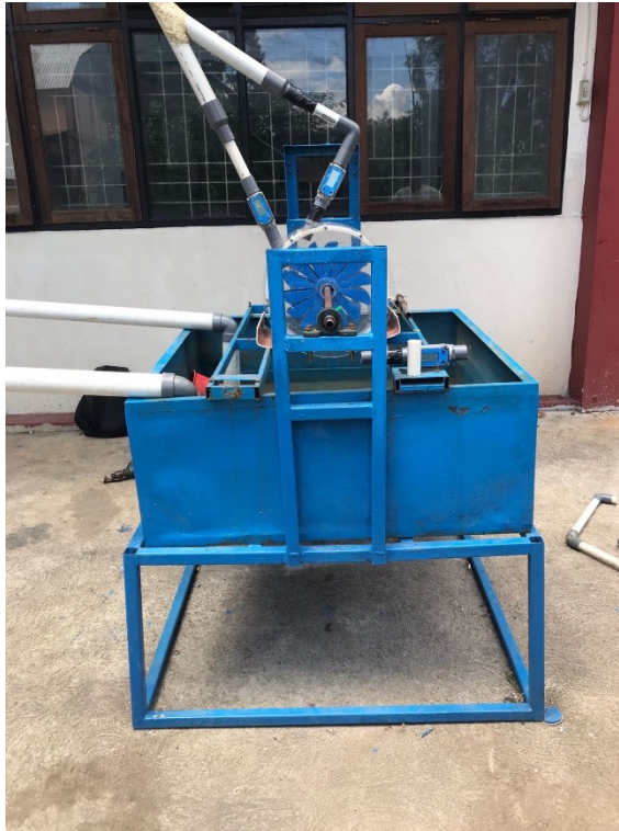
Gambar L. 10 Turbin Turgo Dengan 2 Nozzle
