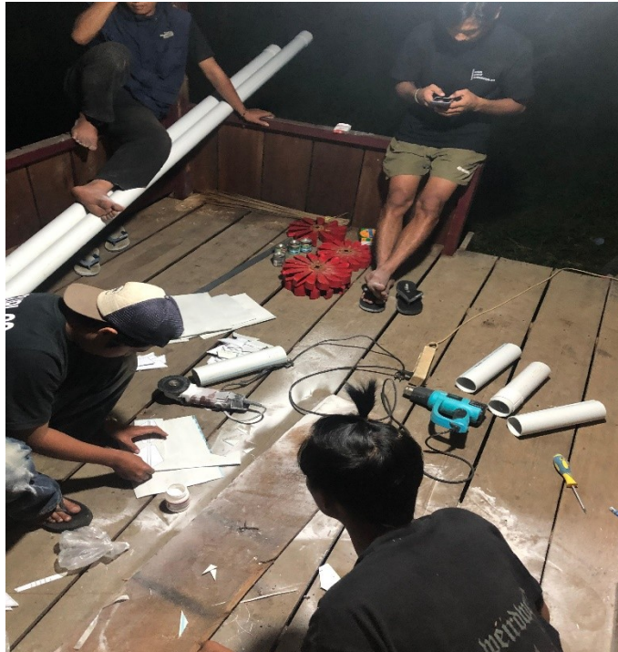
Gambar L. 4 Pemotongan Pipa PVC Untuk Pembuatan Sudu
