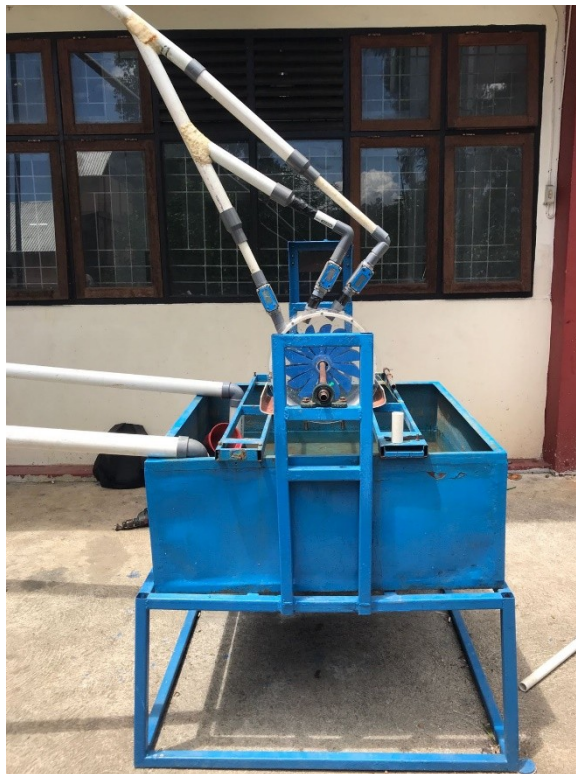
Gambar L. 11 Turbin Turgo Dengan 3 Nozzle
