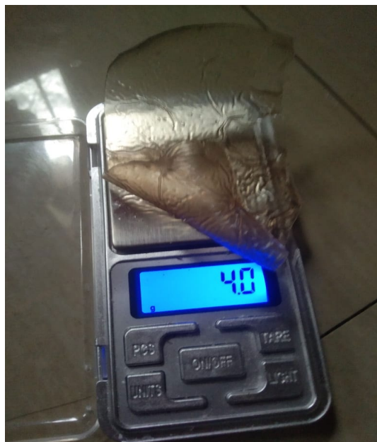
Gambar L.20 Berat spesimen awal untuk water uptake
