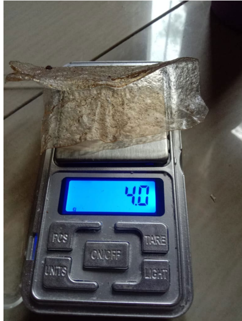
Gambar L.17 Proses pengambilan data awal biodgradasi
