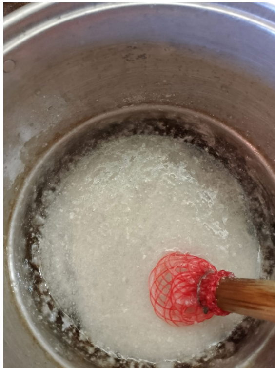
Gambar L.5 Proses mencampur pati, kitosan dan gliserin
