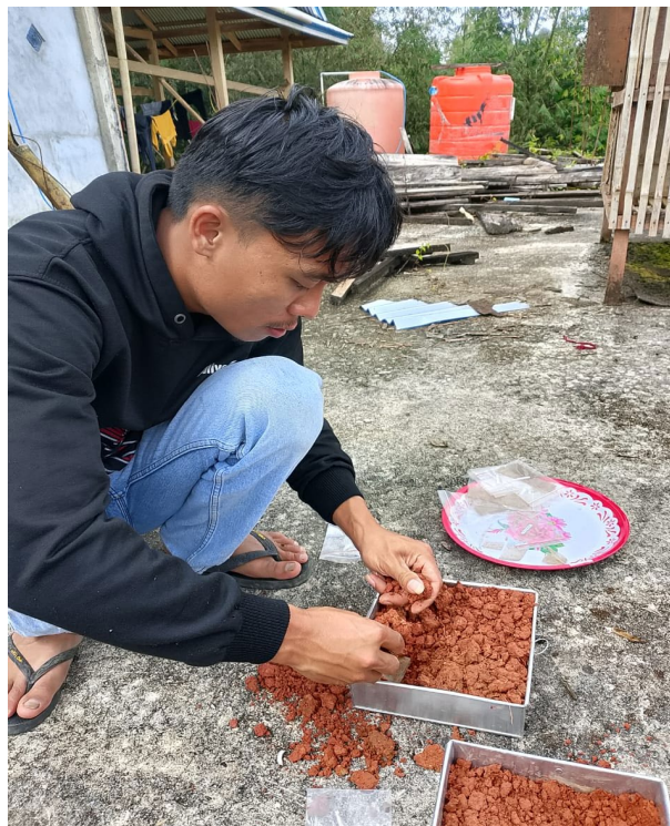
Gambar L.16 proses pengujian biodegradasi (menanam spesimen ke tanah )
