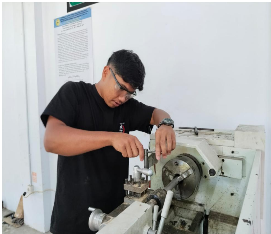
Gambar 6 Proses pemasangan pahat bubut
