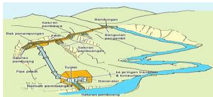
Gambar 2. 1 Skema Pembangkit Listrik Tenaga Mini Hidro
