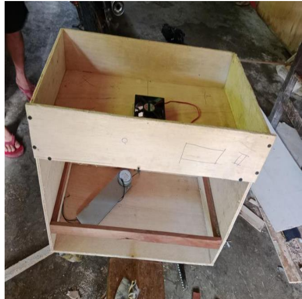
Proses pembuatan alat penetas telur otomatis
