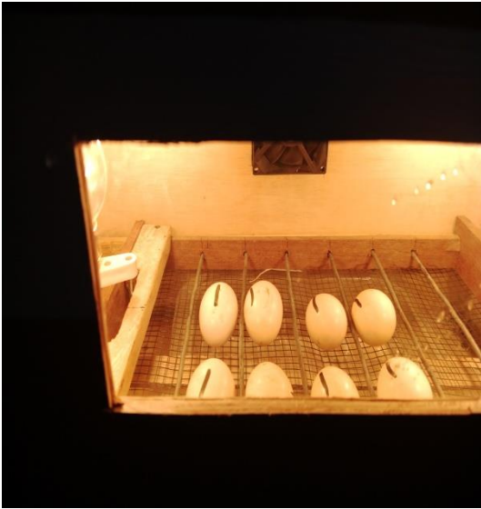
Peletakan telur di atas rak inkubator dengan sistem pemanas lampu pijar
