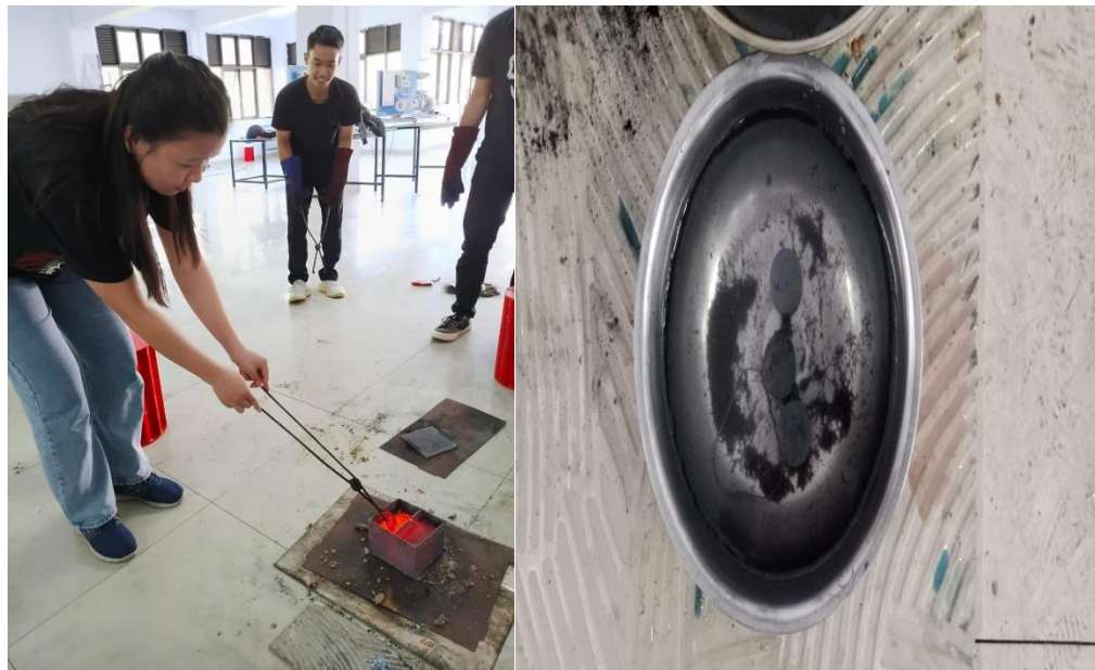
Gambar L. 13 Proses pendinginan spesimen menggunakan media pendingin air
