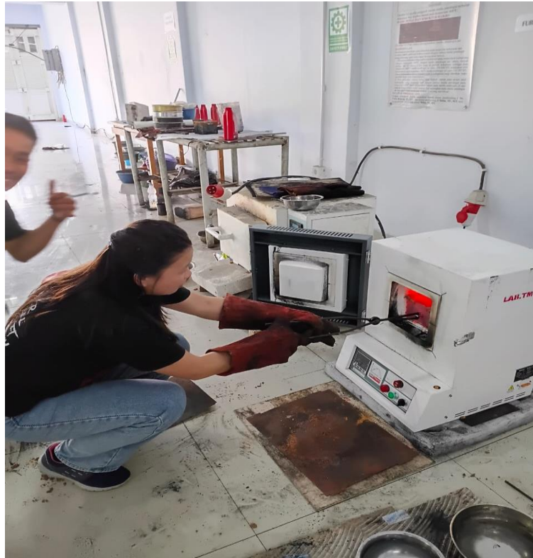
Gambar L. 12 Proses pengangkatan spesimen baja ST 37
