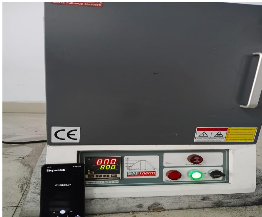
Gambar L. 9 Proses pemanasan spesimen baja ST 37 temperatur 800°C dengan holding time 90 menit
