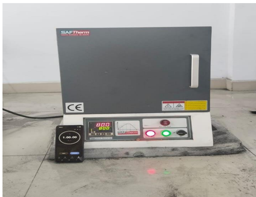
Gambar L. 8 Proses pemanasan spesimen baja ST 37 temperatur 800°C dengan holding time 60 menit
