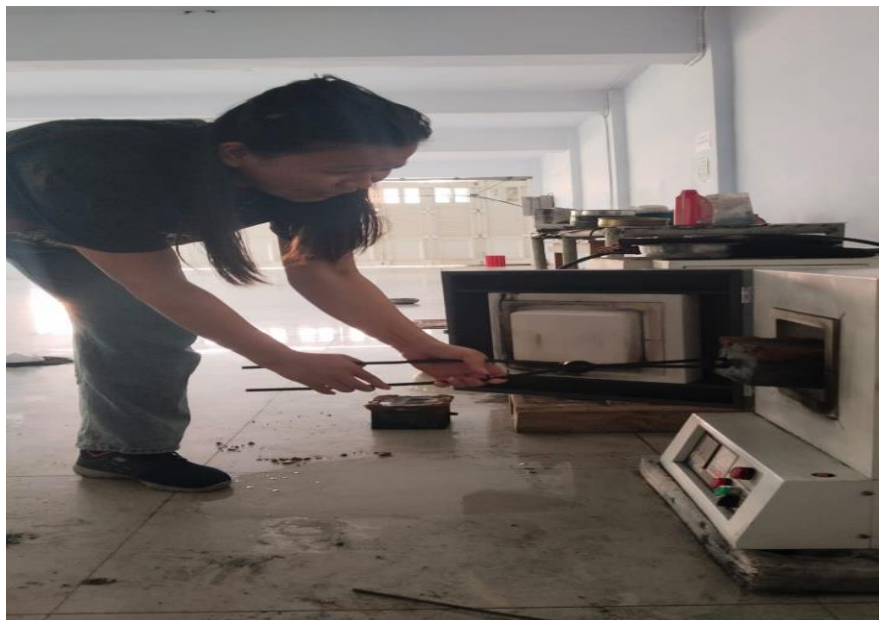
Gambar L. 6 proses memasukan kotak baja kedalam furnice (dapur pemanas)
