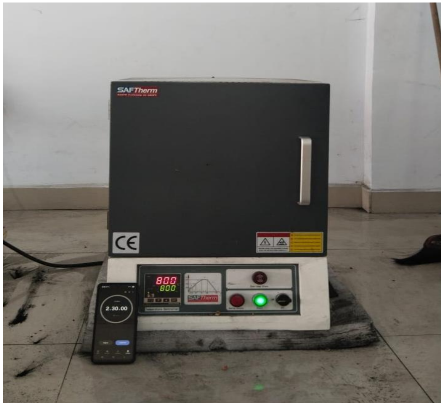
Gambar L. 11 Proses pemanasan spesimen baja ST 37 temperatur 800°C dengan holding time 150 menit
