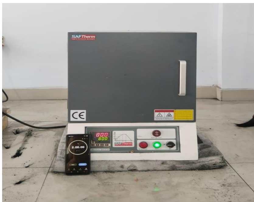
Gambar L. 10 Proses pemanasan spesimen baja ST 37 temperatur 800°C dengan holding time 120 menit
