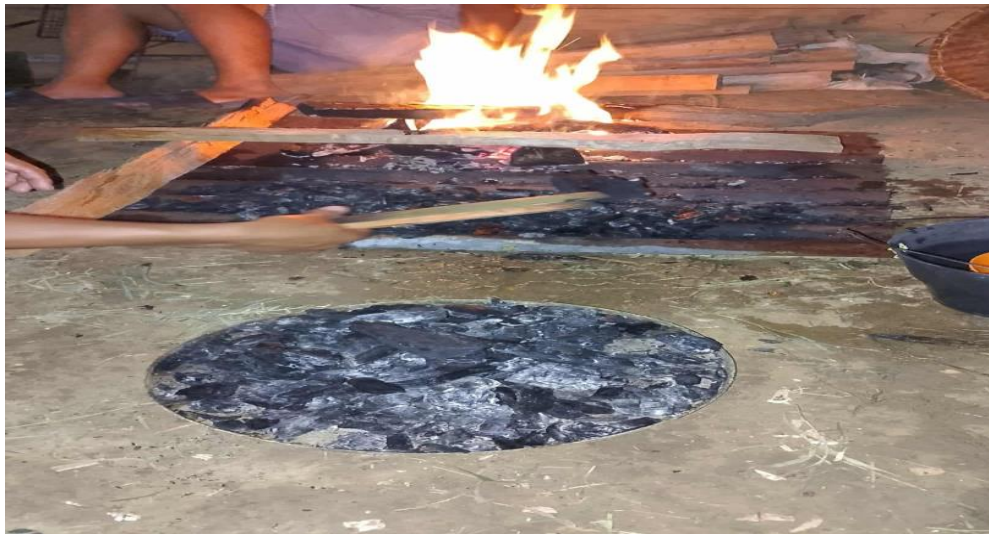
Gambar L. 1 Proses pembuatan arang cemara
