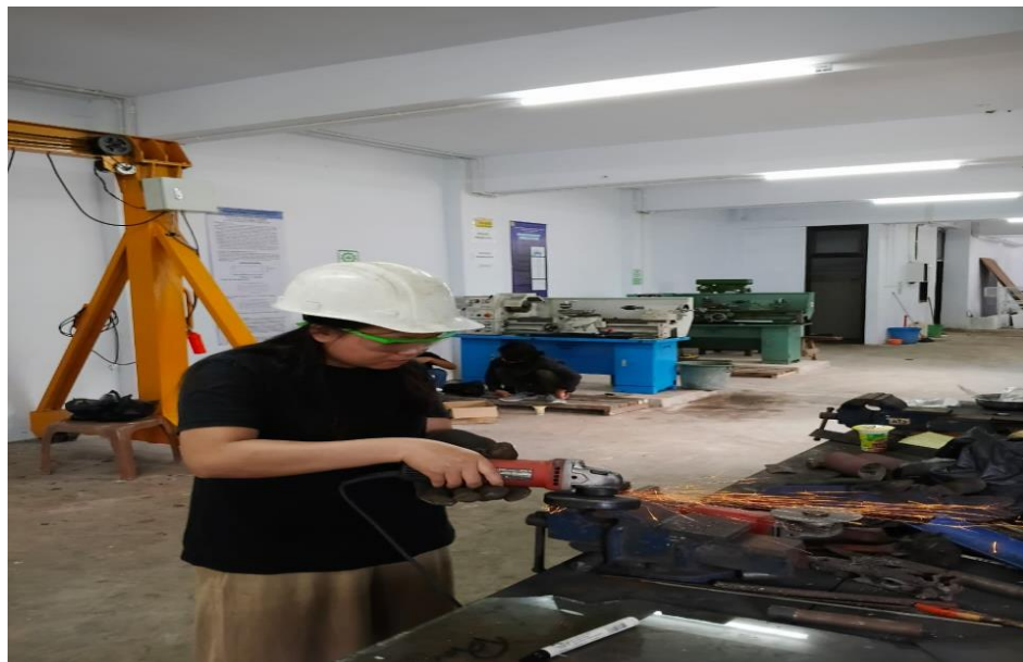
Gambar L. 15 Proses penghalusan permukaan spesimen
