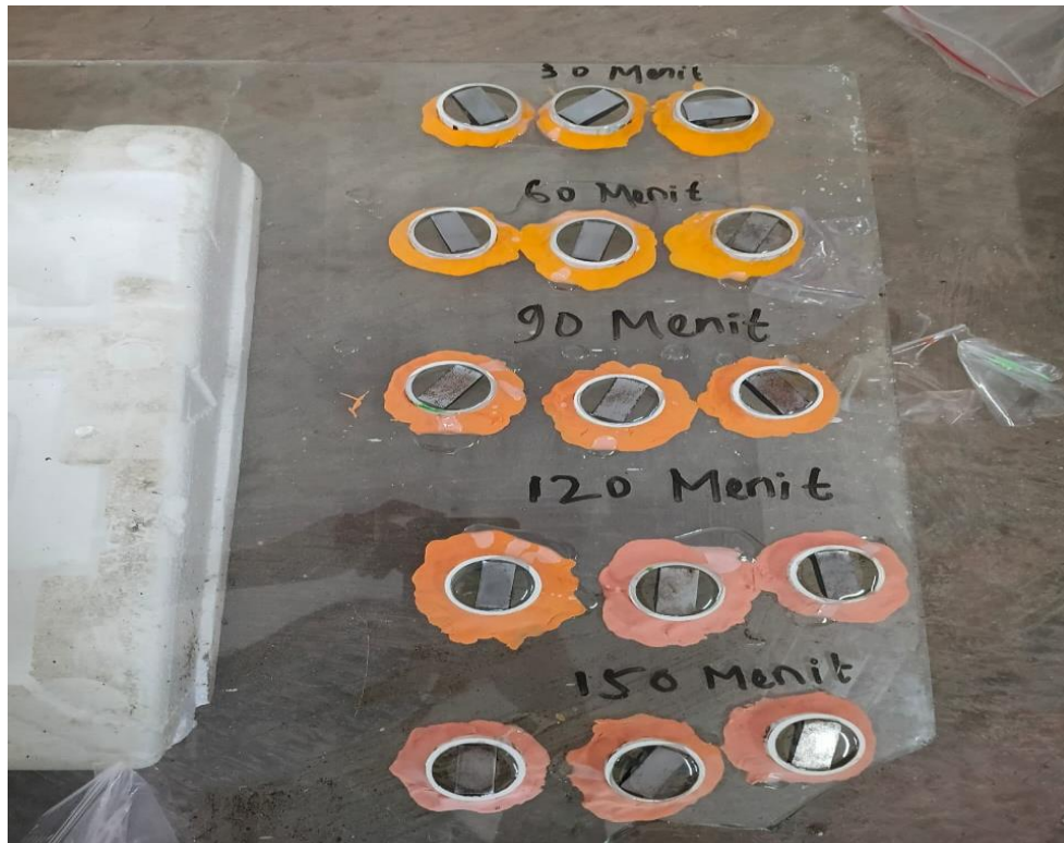
Gambar L. 14 Proses pembuatan cetakan menggunakan resin untuk pengujian kekerasan
