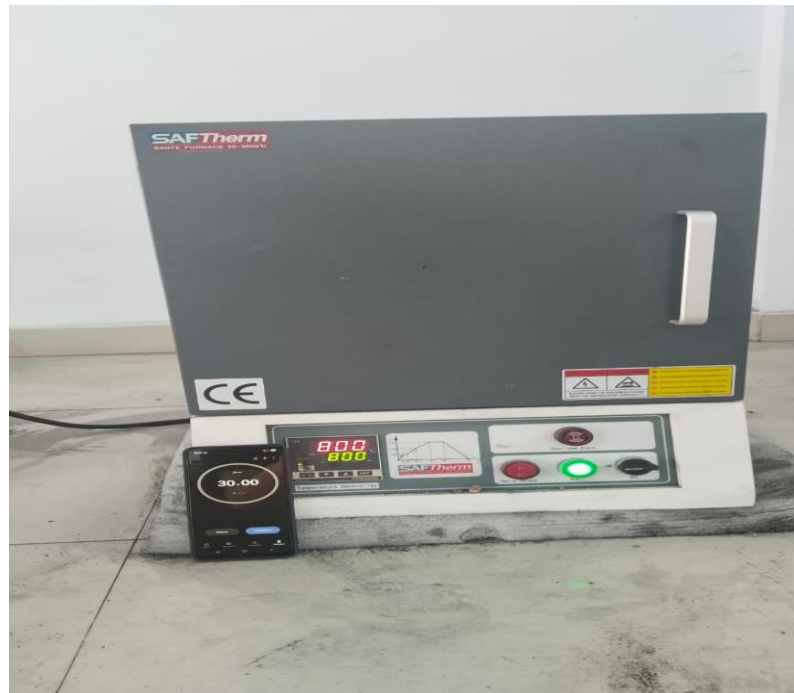
Gambar L. 7 Proses pemanasan spesimen baja ST 37 temperatur 800°C dengan holding time 30 menit
