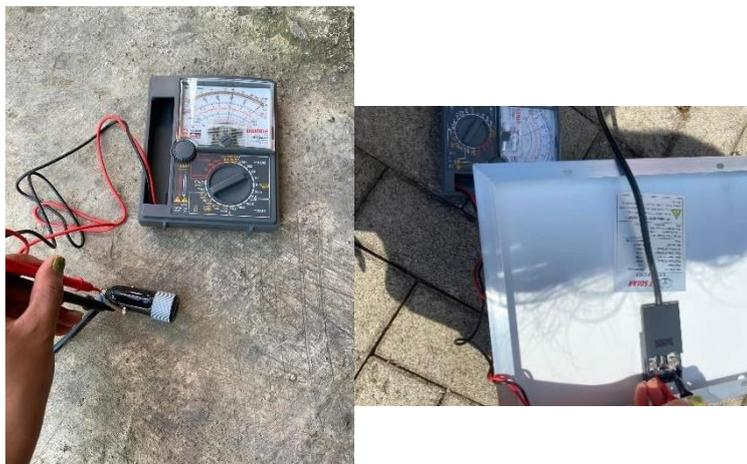
Gambar 4.9 Pengukuran Tegangan dan Arus
