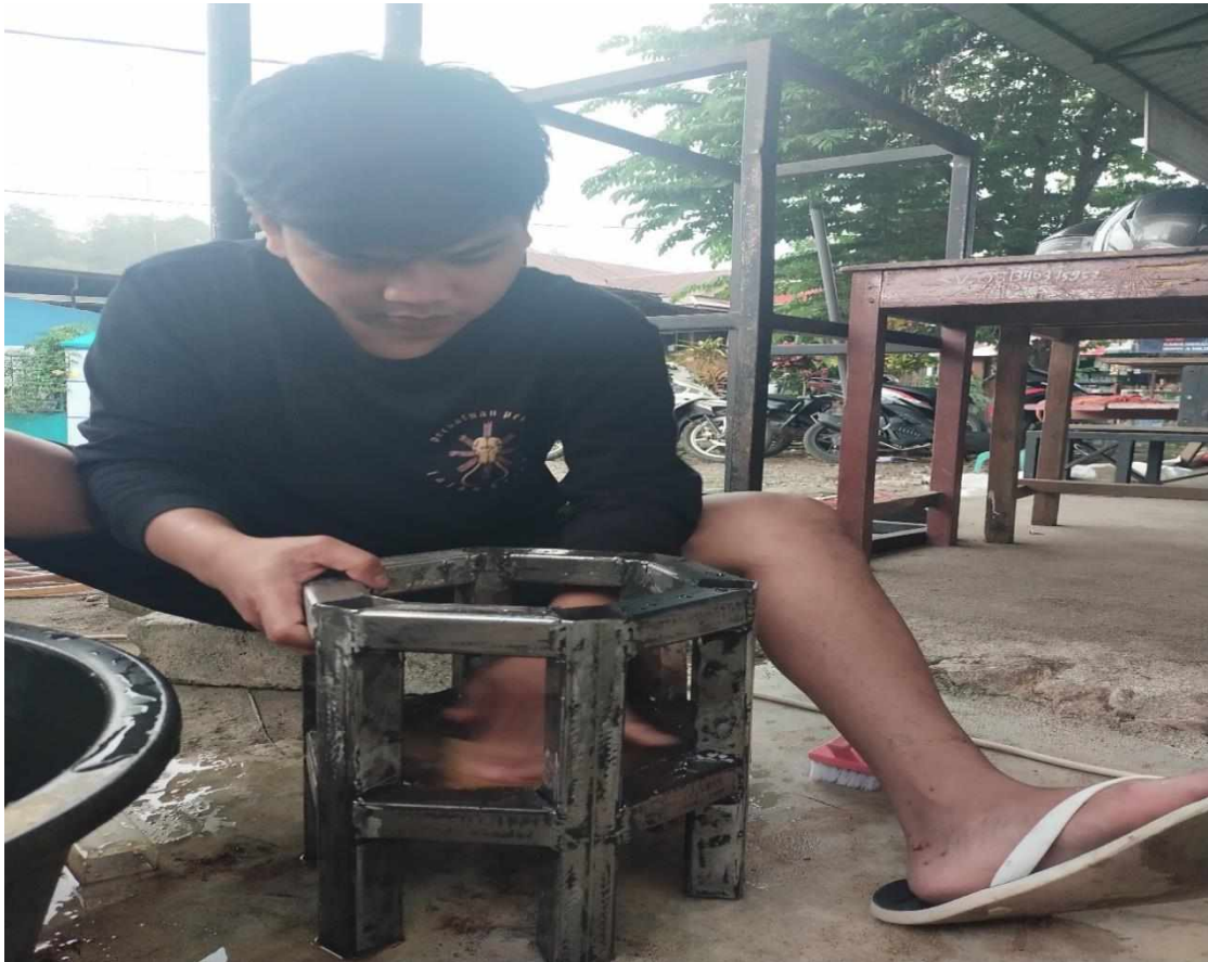
Gambar L.9 Dokumentasi pegemplasan pada tungku
