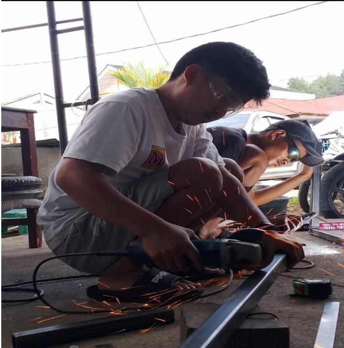
Gambar L.7 Dokumentasi pemotongan pada besi holo 4x4
