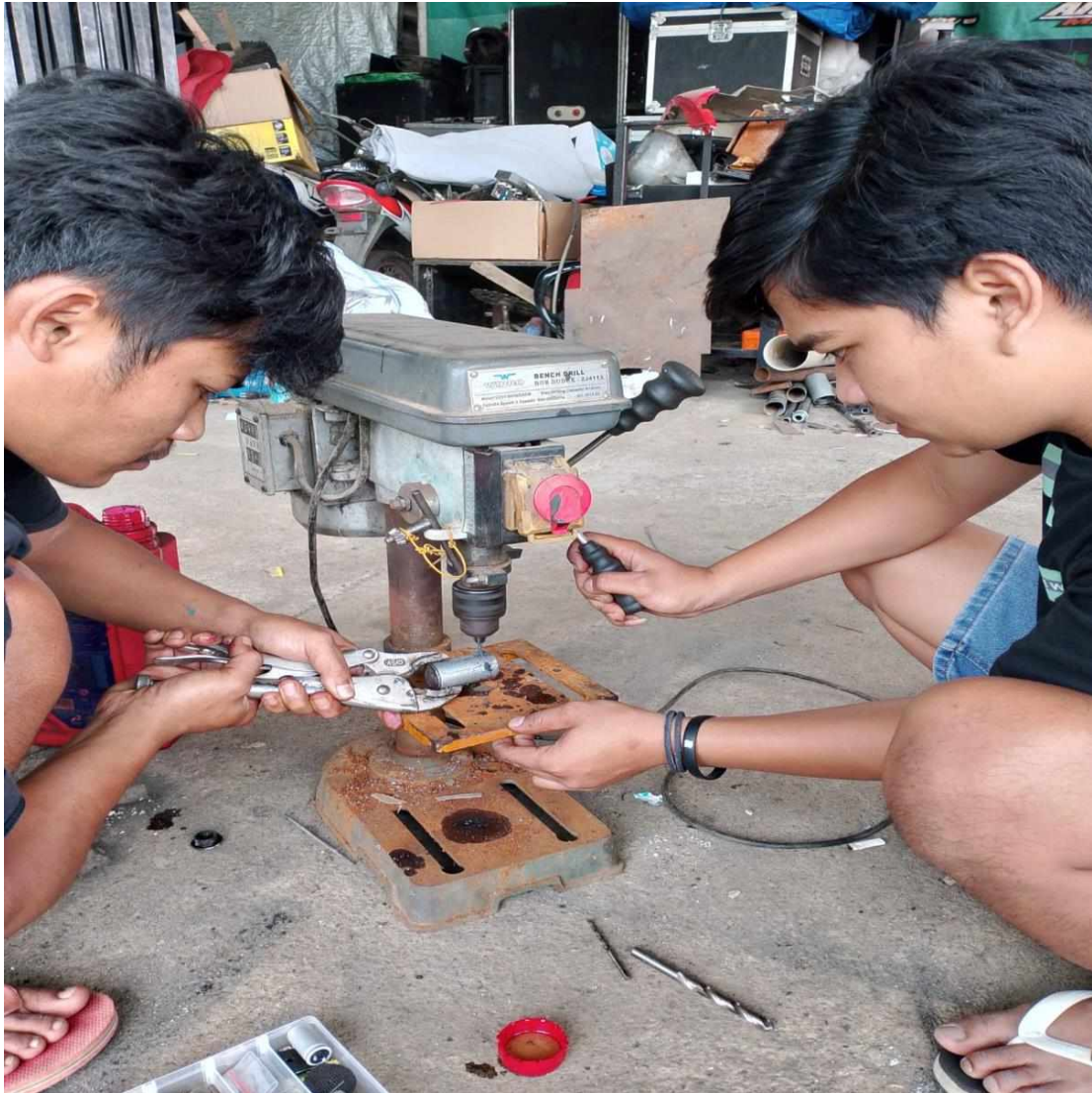
Gambar L.8 Dokumentasi pengeboran pada nozzle burner
