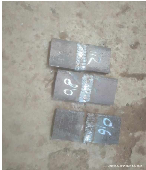
Gambar L 3. Pengelasan kampu V
