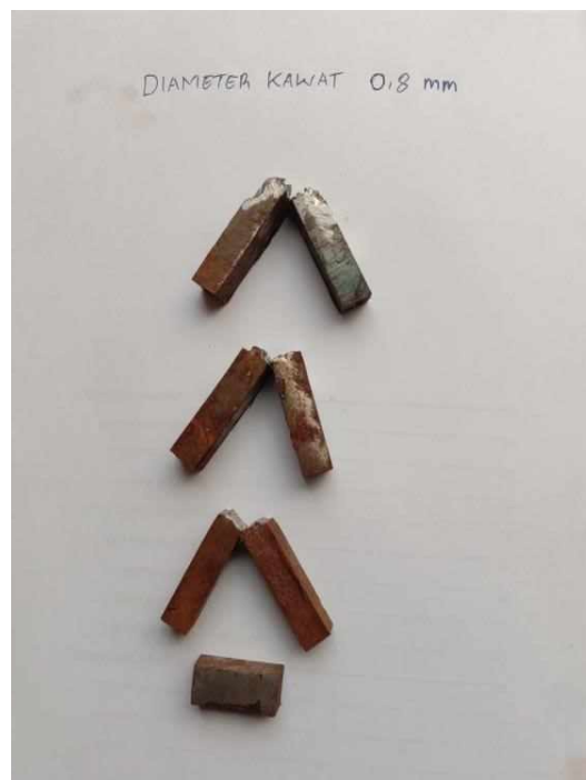
Gambar L 15. Hasil pengujian diameter kawat 0,8 mm ketangguhan dan struktur mikro
