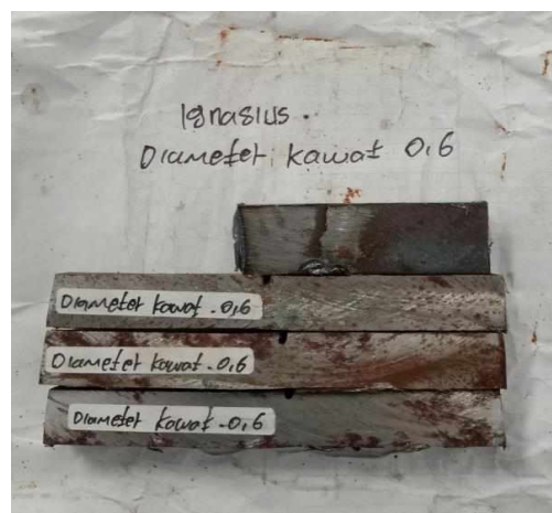
Gambar L 7. Spesimen Diameter Kawat 0,6 mm
