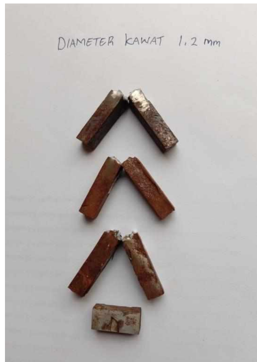
Gambar L 14. Hasil pengujian diameter kawat 1,2 mm ketangguhan dan struktur mikro
