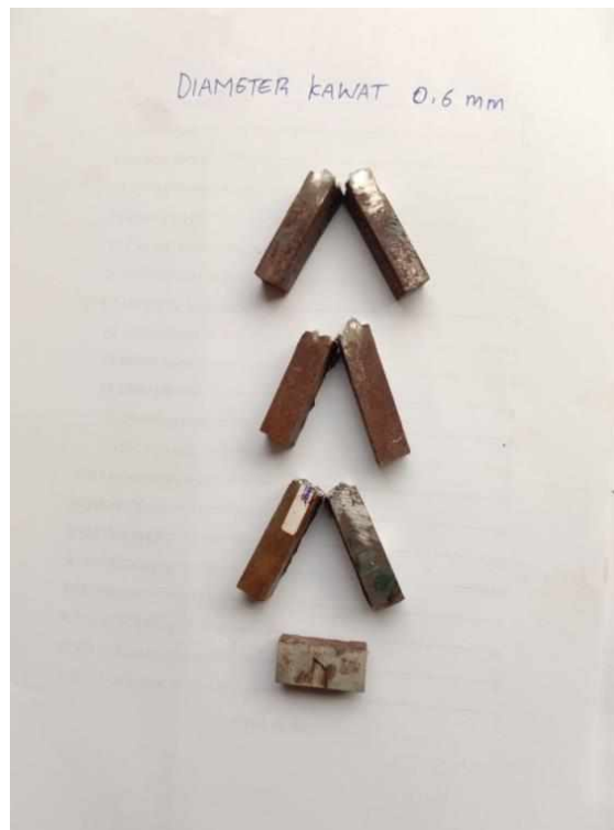
Gambar L 16. Hasil pengujian diameter kawat 0,6 mm ketangguhan dan struktur mikro
