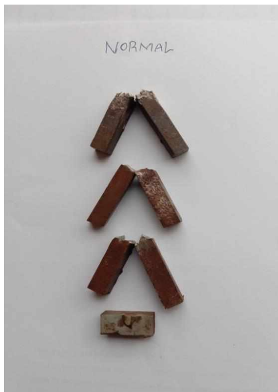
Gambar L 13. Hasil pengujian normal ketangguhan dan struktur mikro
