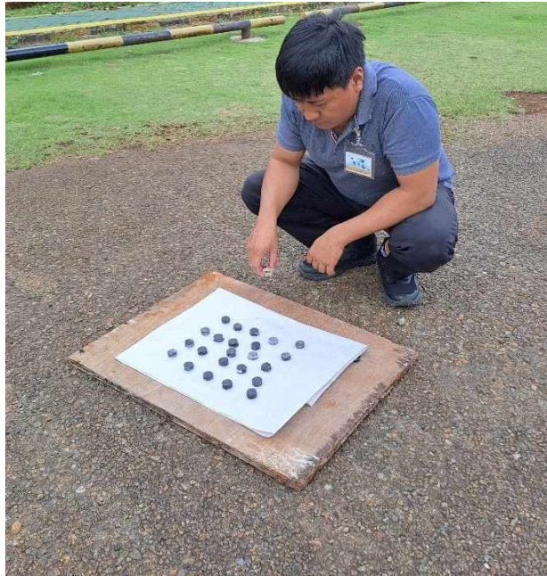
L2.1.2 Penjemuran Spesimen Uji
