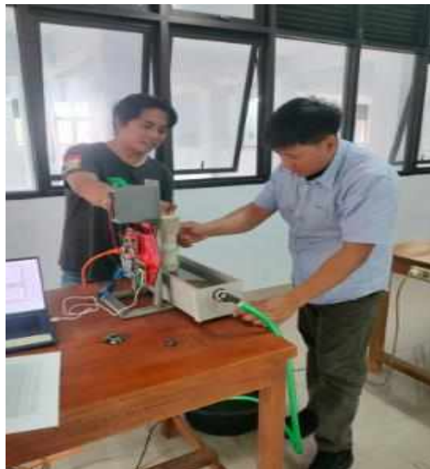
L2.2.2 Pemasangan Kabel Termokopel pada alat Uji
