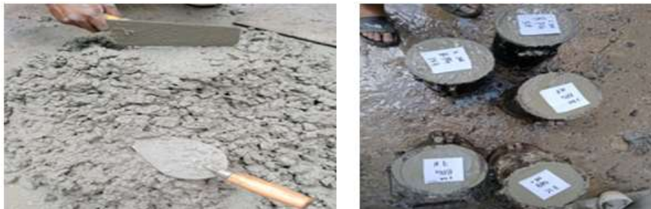
Gambar 2. Pembuatan benda uji silinder
