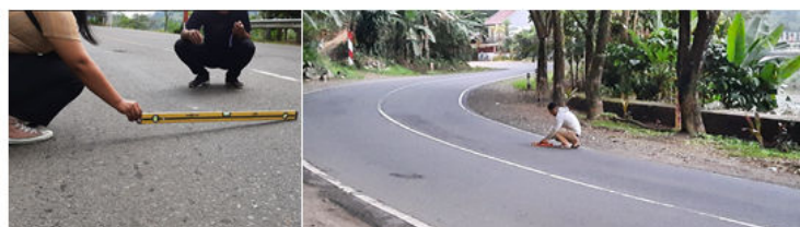
Gambar 2. Pengukuran sudut kemiringan Jalan
