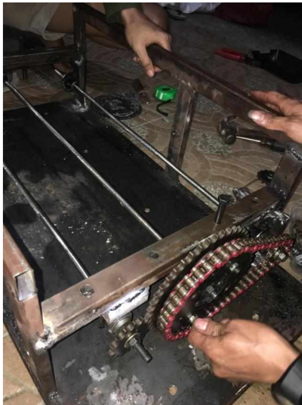
Gambar L. 6 Pemasangan sistem transmisi pada speed bump
