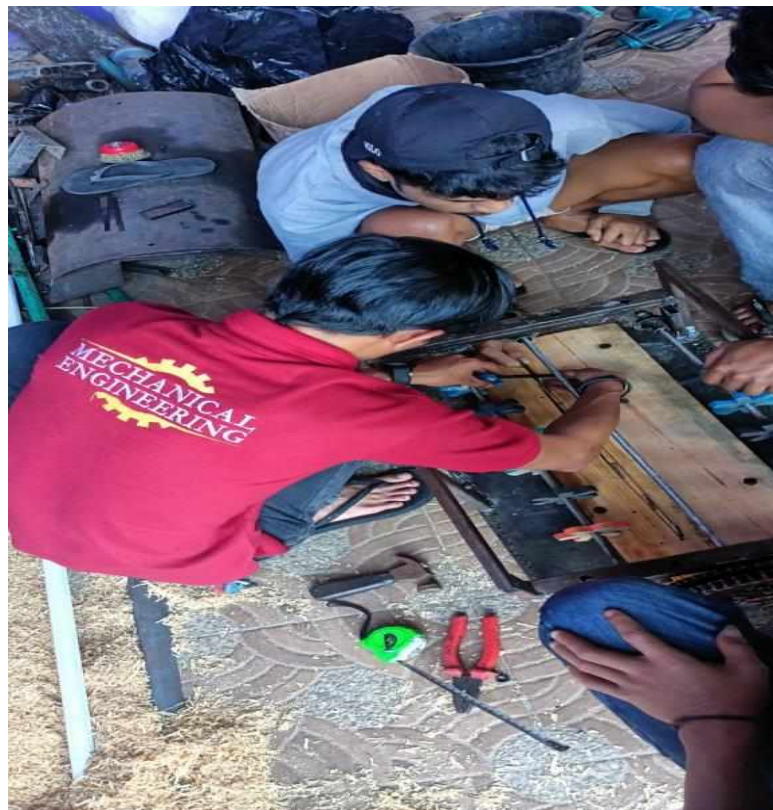
Gambar L. 8 Pengukuran dan pemasangan gigi penekan speed bump
