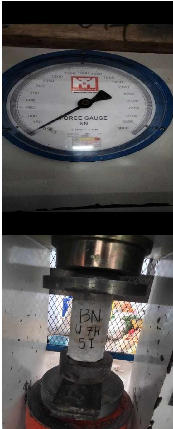
Gambar 25. Pengujian kuat tekan beton kontrol pada umur 7 hari
