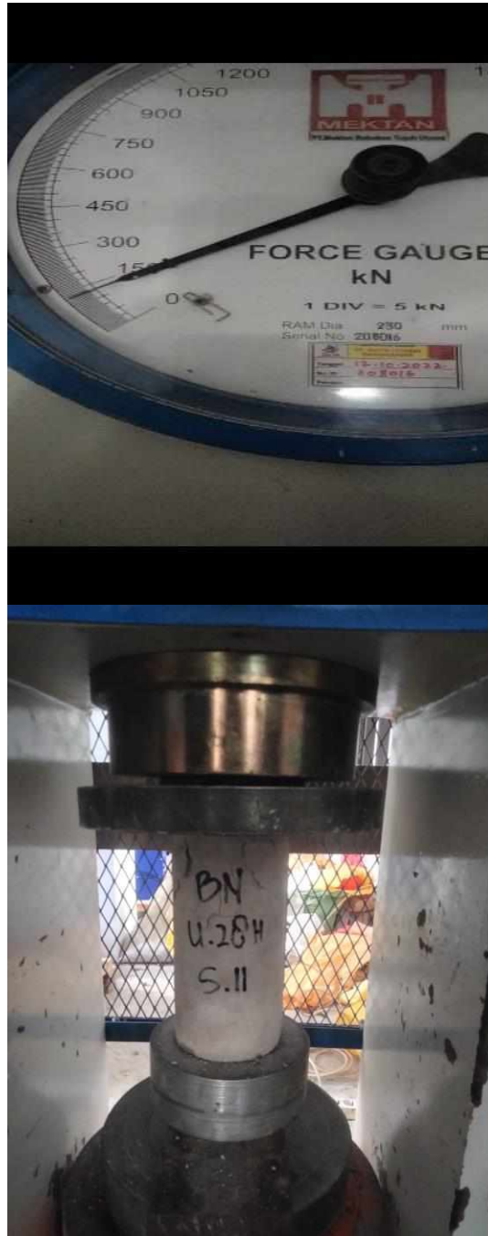
Gambar 27. Pengujian kuat tekan beton kontrol pada umur 28 hari
