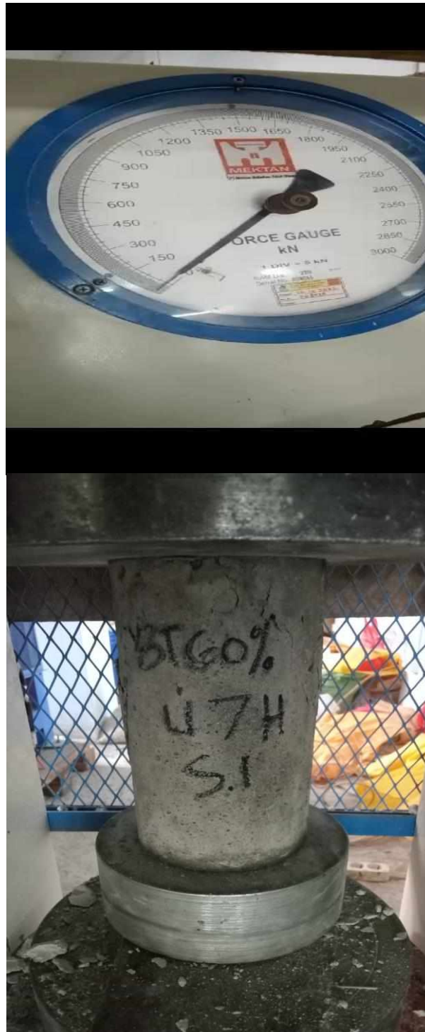
Gambar 37. Pengujian kuat tekan beton plastik polypropylene 60% untuk umur beton 7 hari
