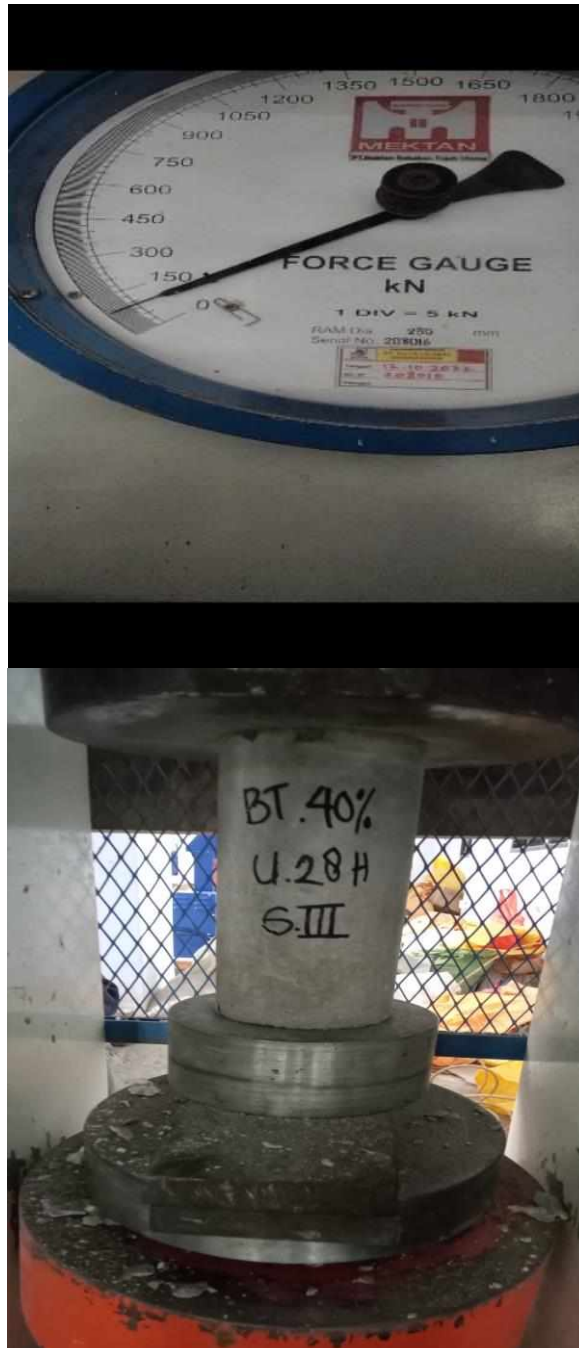
Gambar 31. Pengujian kuat tekan beton plastik polypropylene 40% untuk umur beton 28 hari
