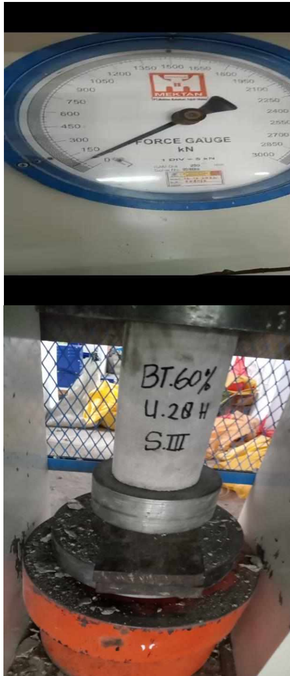
Gambar 39. Pengujian kuat tekan beton plastik polypropylene 60% untuk umur beton 28 hari
