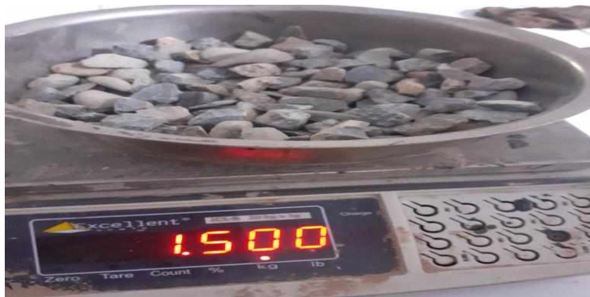
Gambar 3. Sampel agregat kasar untuk pengujian analisa saringan
