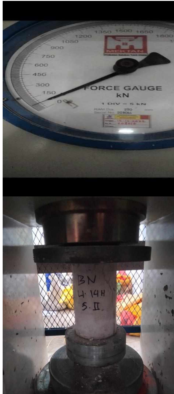
Gambar 26. Pengujian kuat tekan beton kontrol pada umur 14 hari
