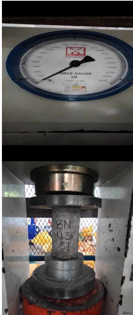
Gambar 24. Pengujian kuat tekan beton kontrol pada umur 3 hari
