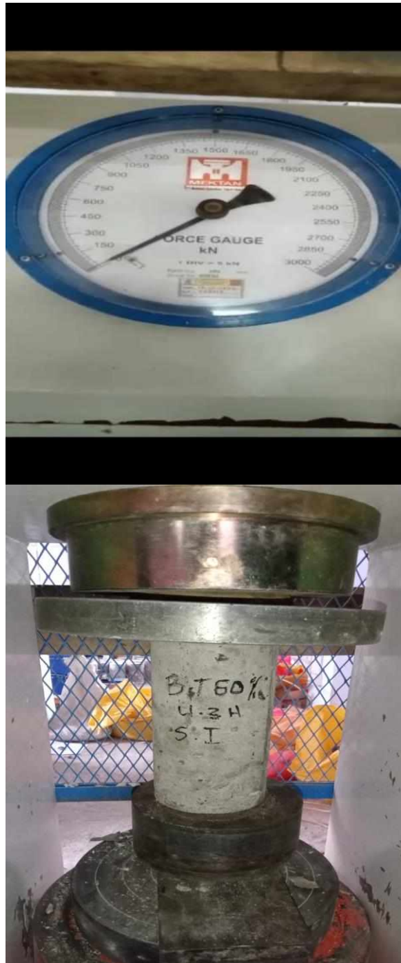
Gambar 36. Pengujian kuat tekan beton plastik polypropylene 60% untuk umur beton 3 hari
