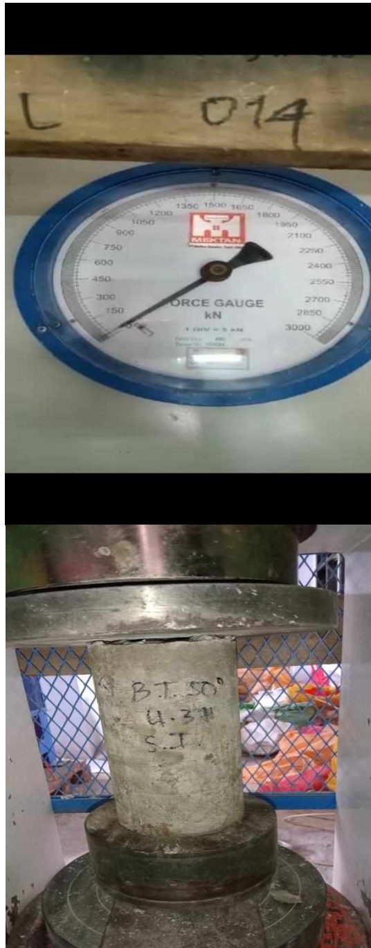
Gambar 32. Pengujian kuat tekan beton plastik polypropylene 50% untuk umur beton 3 hari
