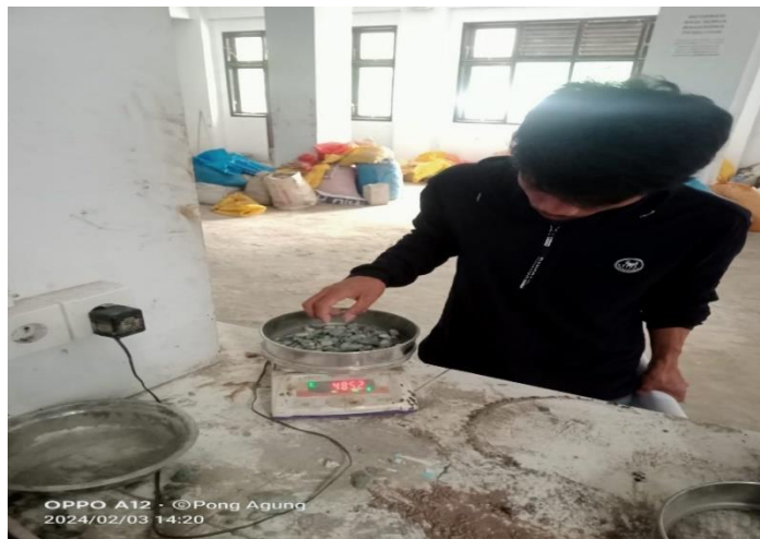
Proses Menimbang Agregat
