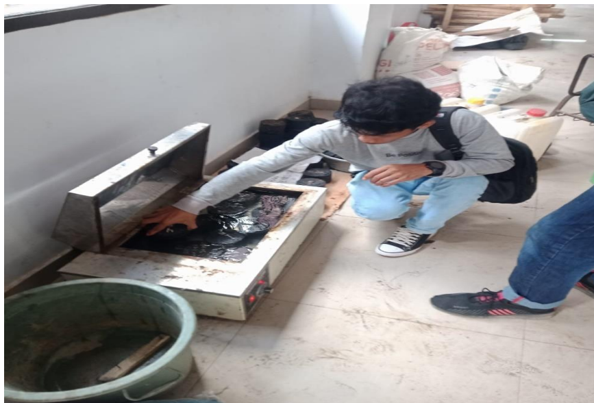
Perendaman Benda Uji Dengan Air Laut
