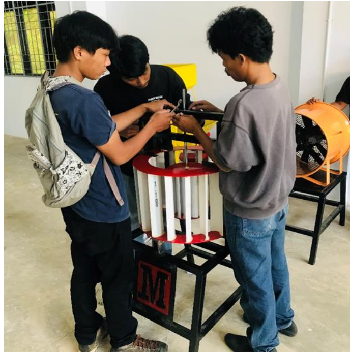
Gambar L. 25 Pemasangan Rotor dan Cylindrical Guide Vane
