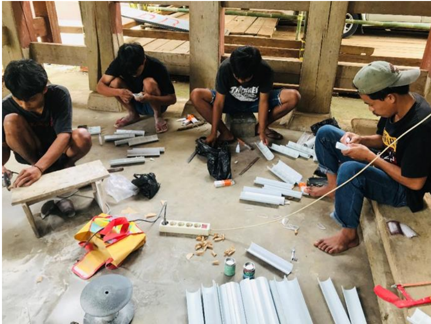
Gambar L. 21 Pemasangan sudu dan sirip
