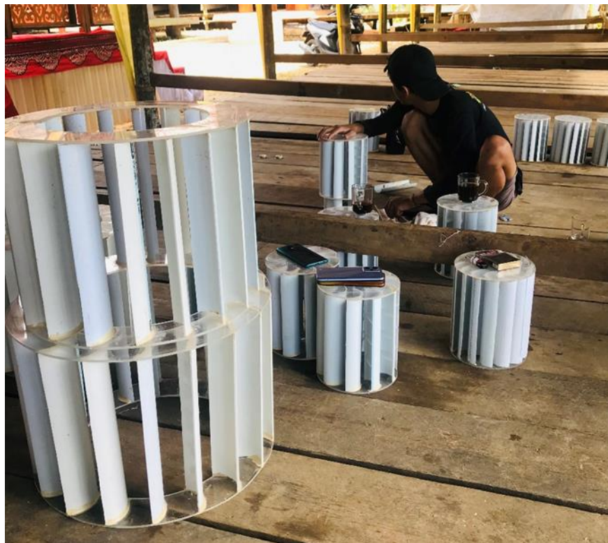
Gambar L. 22 Rotor dan Cylindrical Guided Vane setelah pemasangan
