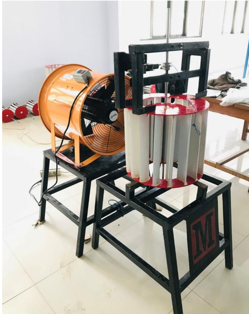
Gambar L. 27 Turbin angin Crossflow 14 sudu menggunakan Cylindrical guide vane
