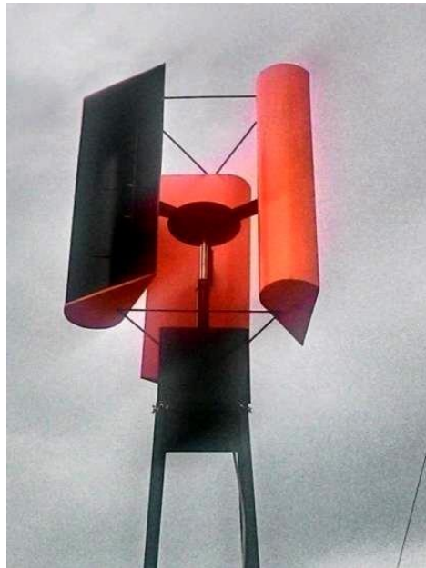
Gambar 2. 5 Model kincir angin sumbu vertikal jenis Lenz2 setelah di rakit Sumber: (Yusuf Ismail Nahkoda dan Choirul Saleh, 2017)
