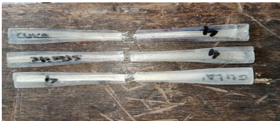
Foto di atas menunjukkan bentuk setelah pengujian kekuatan tarik
