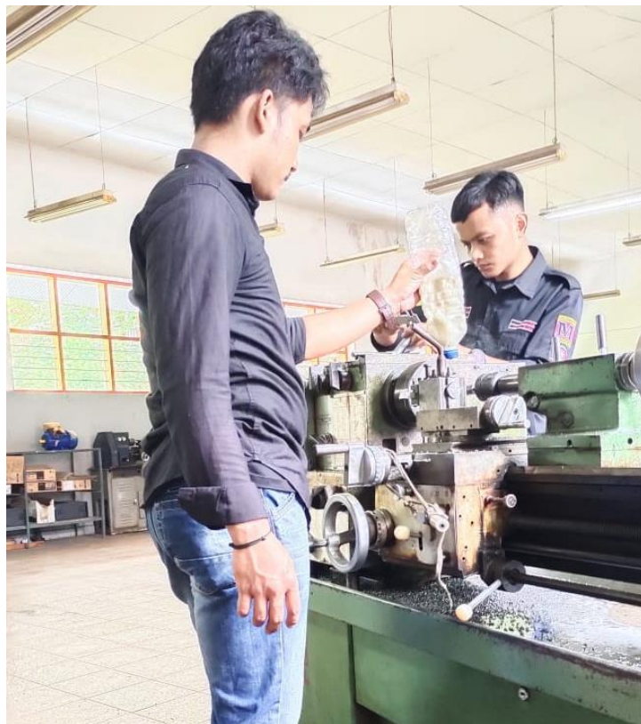
L4. Pembubutan spesimen Baja ST 42
